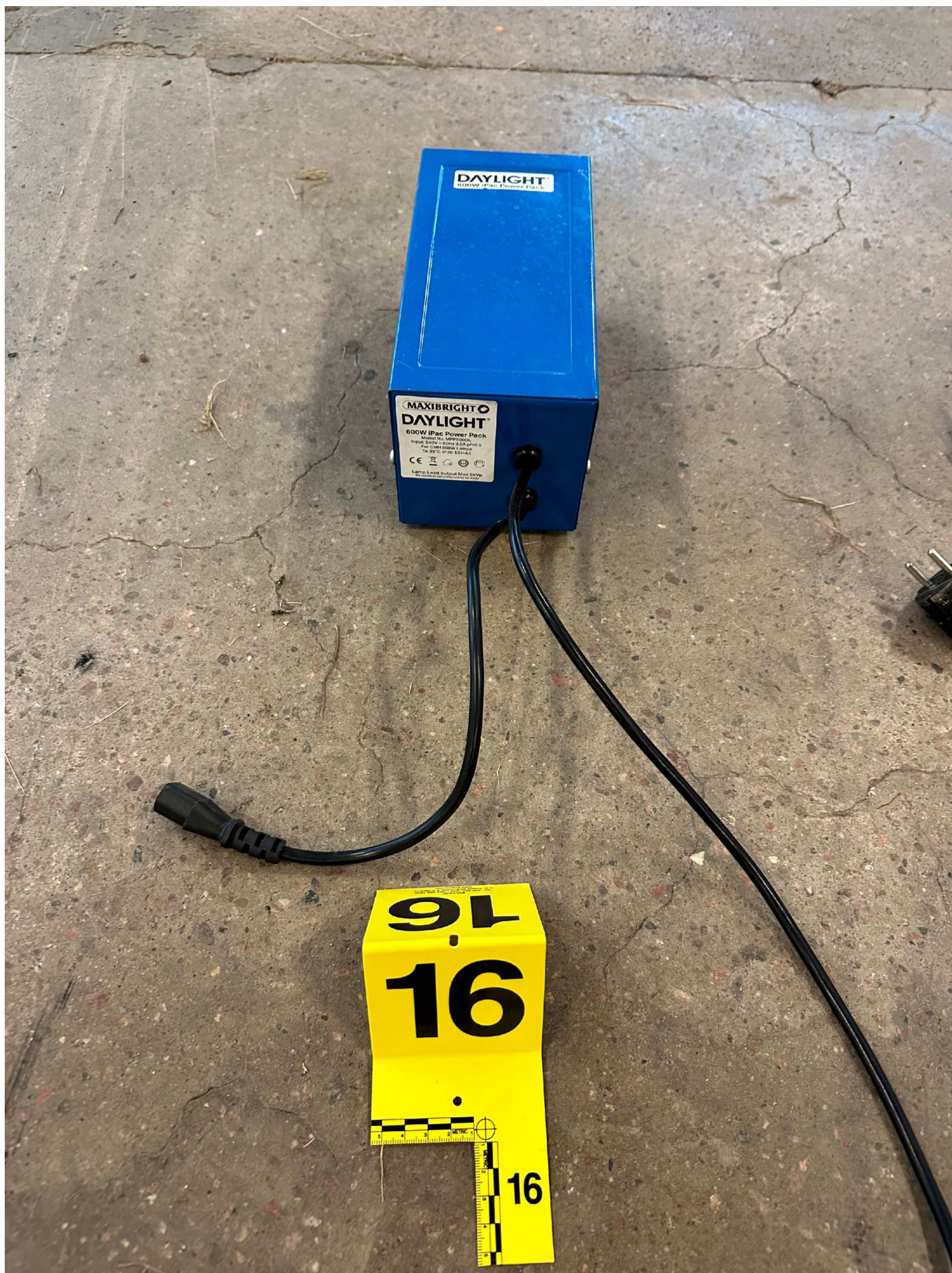
16. 16. Transformator. DayLight. Elektrisk ballast 600W.
