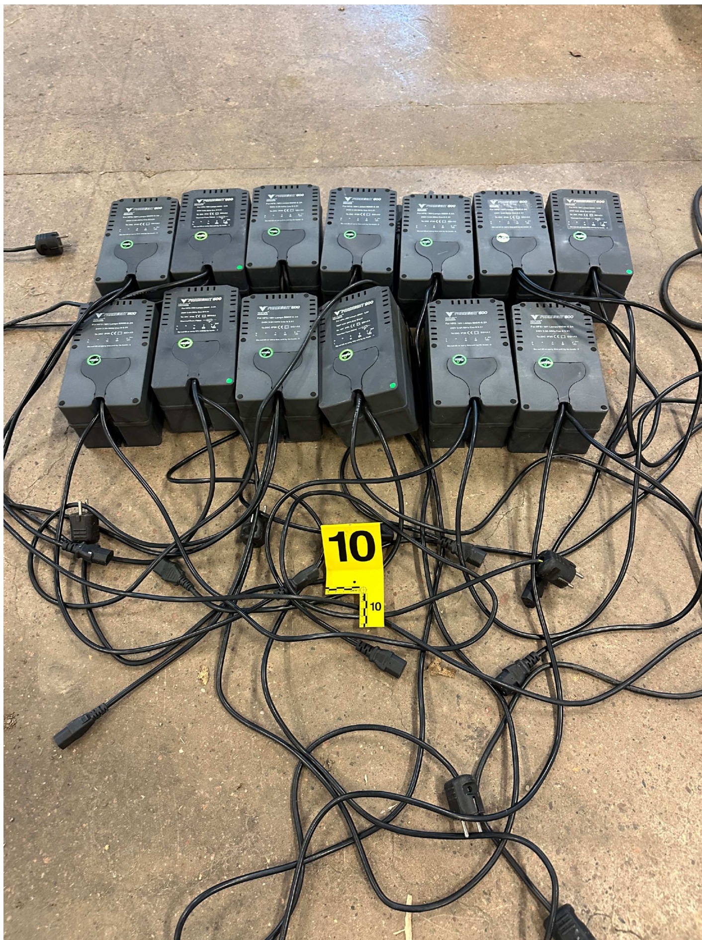
10. 10. Transformatorer Venture Lightning. Elektrisk ballast 600W.
