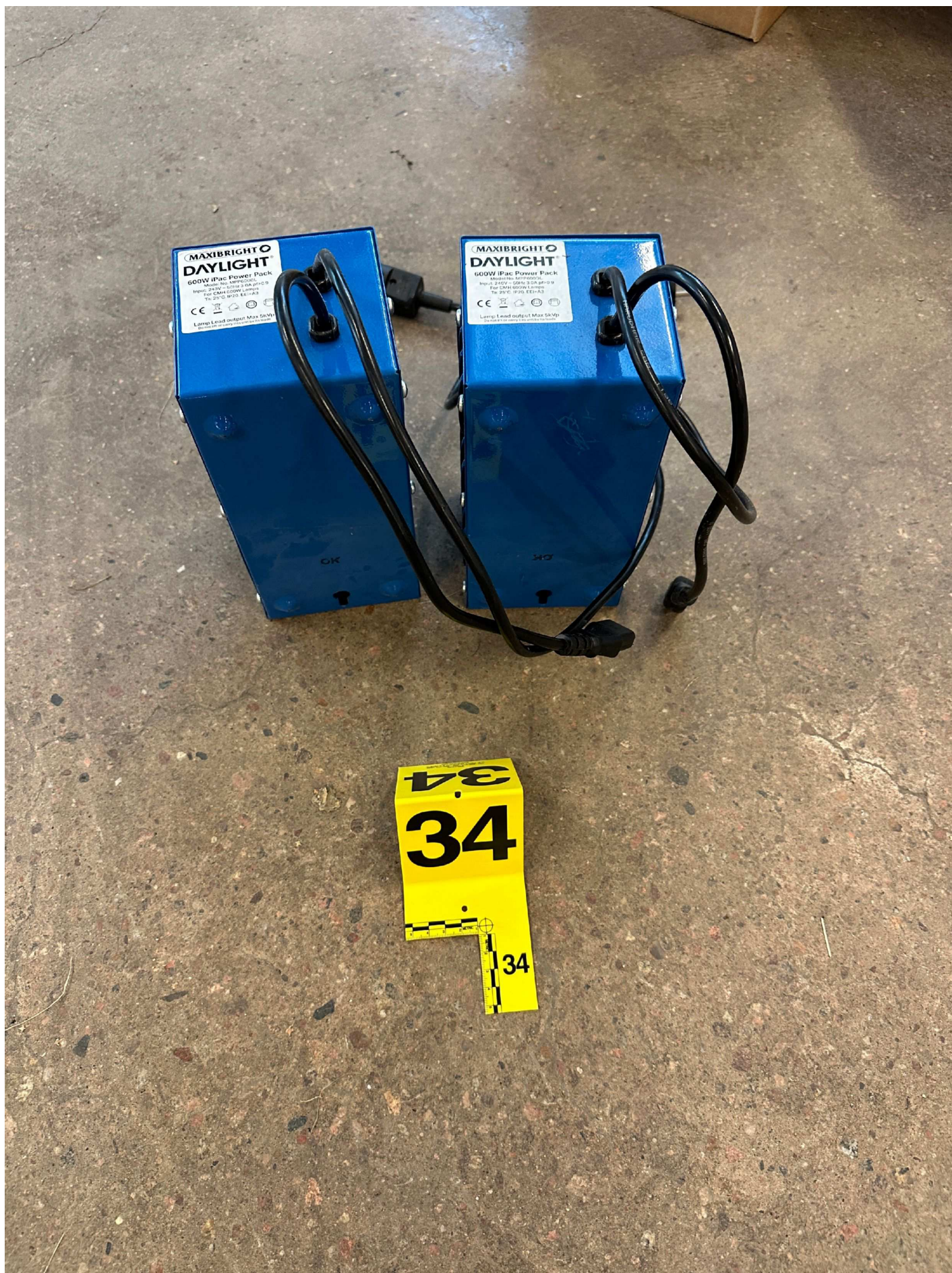
34. 34. 2 stycken transformatorer. Daylight. Elektrisk Ballast 600W.
