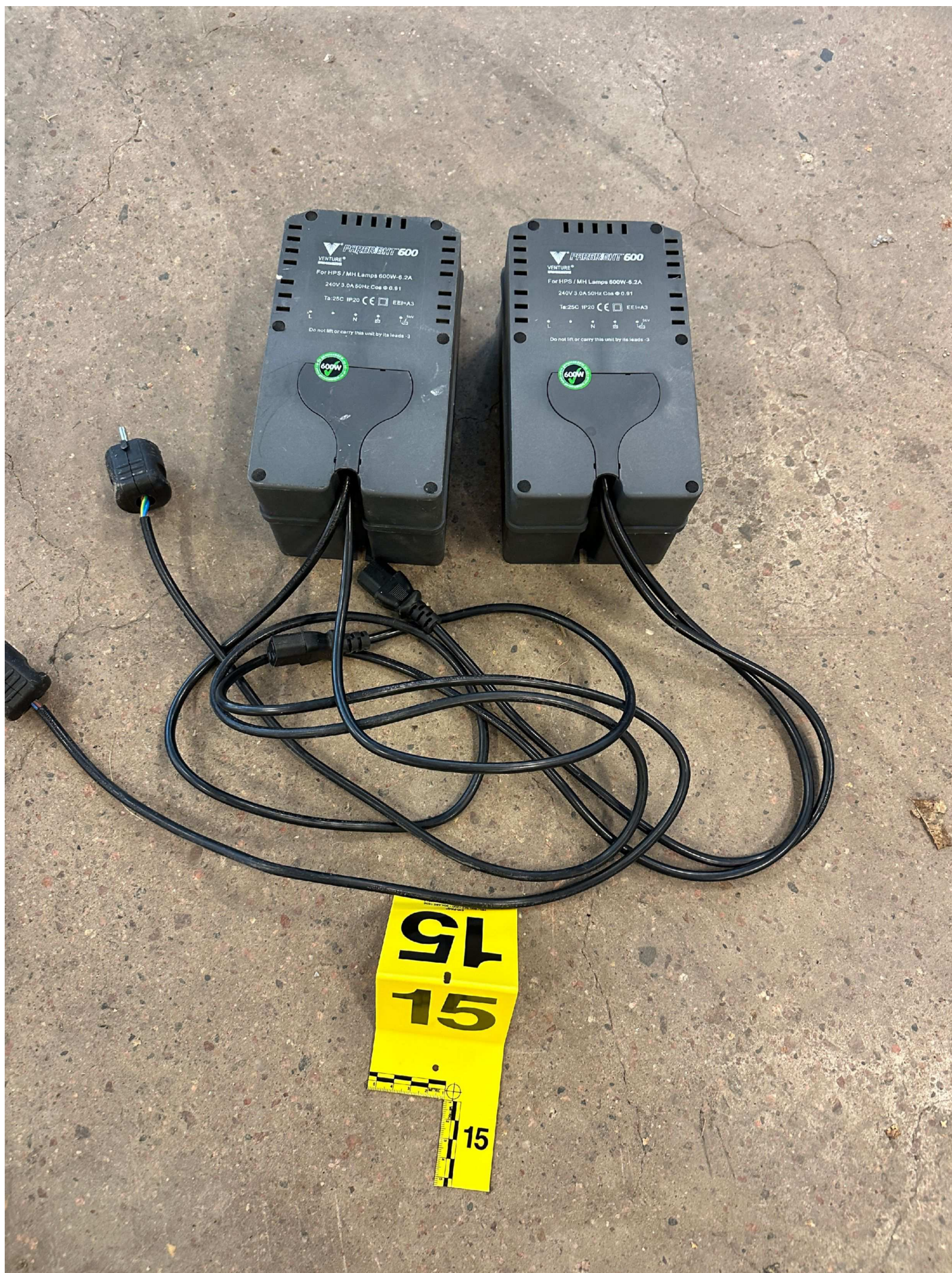
15. 15. Transformatorer. Venture Lightning. Elektrisk ballast 600W.
