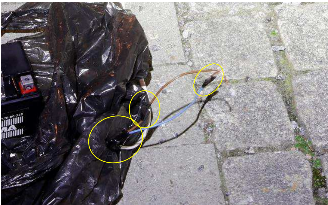
Figur 27. I den vita kabelns ände ses svart isoleringstejp virad runt en blå och en brun kabel. (I bilden ses också två svarta skuggor av den blå och den bruna kabeln.)
