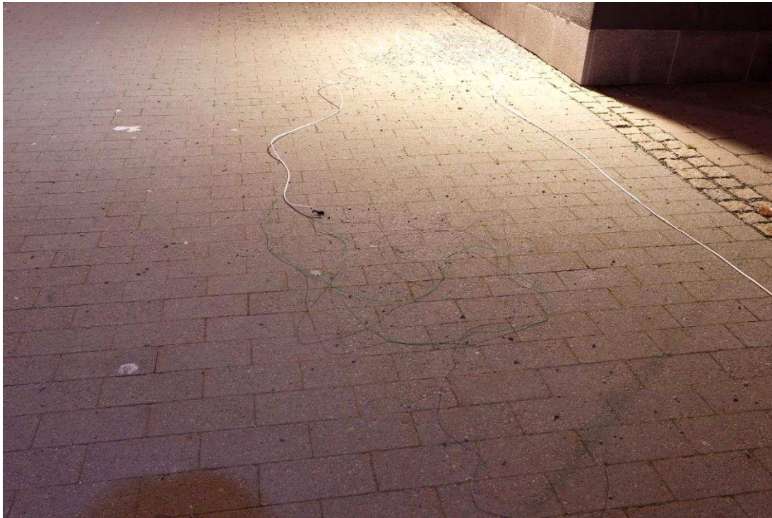
Figur 28. Den vita kabeln närmast detonationsplatsen. Två tunna kablar hade fästs vid den vita kabeln med svart isoleringstejp.
