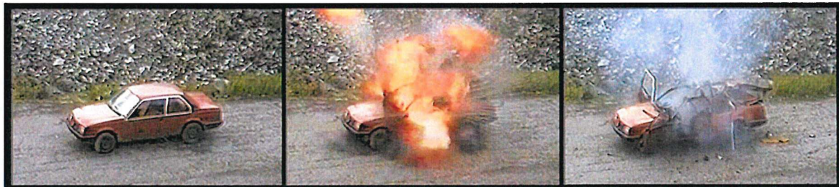
Figur 1. Invändig detonation av 250 g sprängämne. Före, under och efter detonation.
