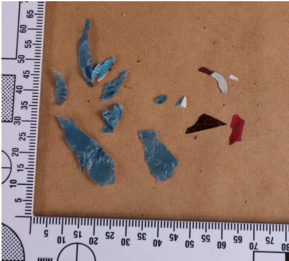
Figur 7. Blå plastliknande fragment med fransiga kanter, G008, anträffade ca 2,5 meter från detonationsgropen. De rödaktiga flagorna till höger i bild bedöms härröra från den rödlackerade plåtbeklädnaden på utbyggnaden.
