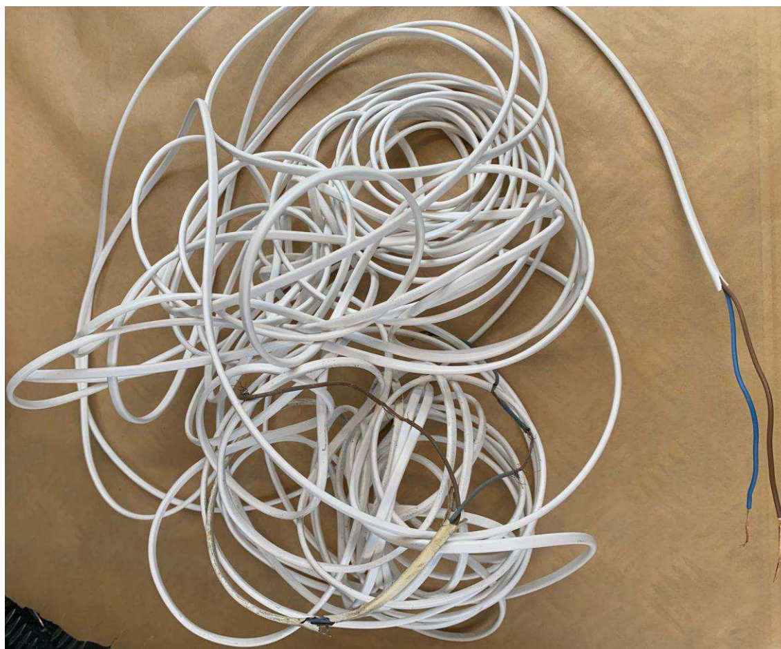
Figur 17. Elkabel, G002. Den del av elkabeln som låg vid batteriet syns till höger i bild och den ände som låg närmast detonationsområdet syns centralt i kabelhärvan.
