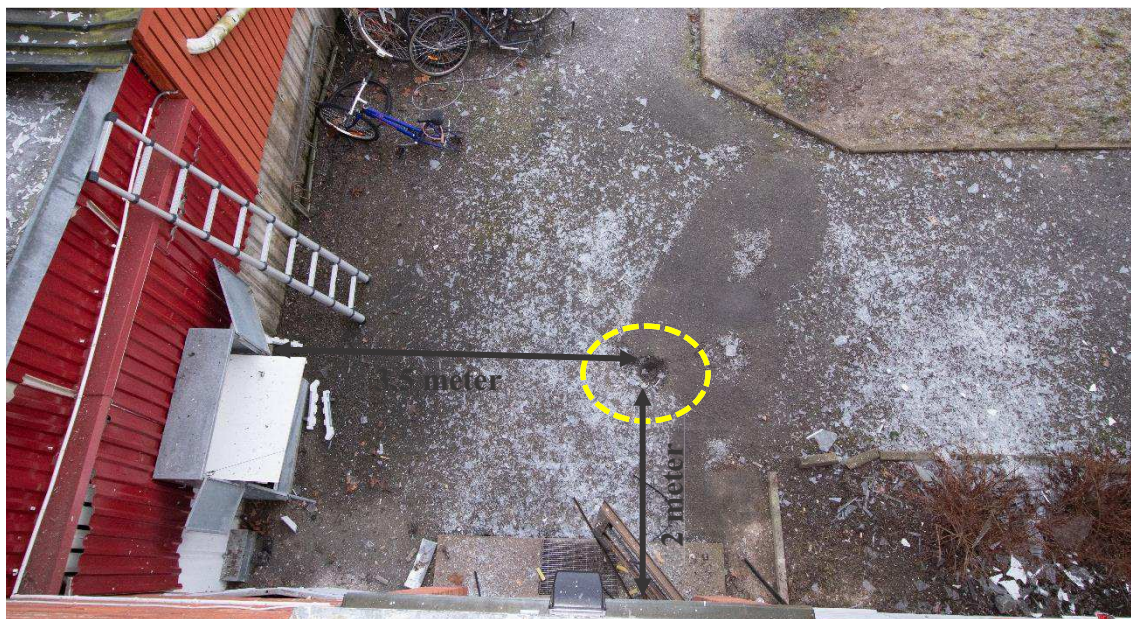
Figur 8. Detonationsområdet utanför entrén fotograferat från trapphuset efter att delar av markmaterialet sopats ihop. Detonationsgropen är inringad. Stegen till vänster i bilden tillhör polisen.
