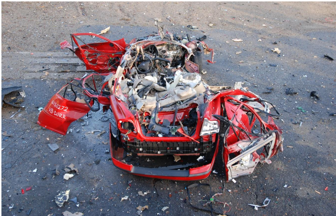
Figur 1. Detonation av ca 2 kg dynamitsprängämne i en bil.
