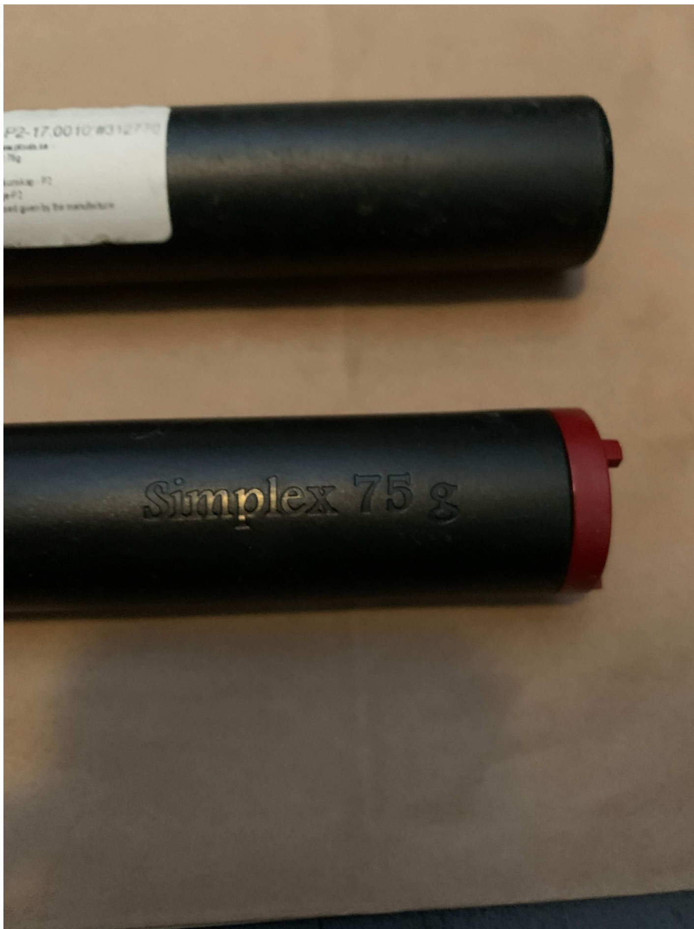
15. Närbild på bergspräckningspatroner som anträffades i den vänstra lådan. Märkt med "Simplex 75".
