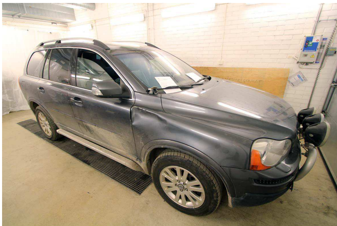
Figur 2 Höger skärm har en intryckning i plåten
