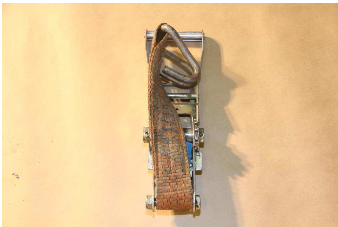
Bild 20. Lastspännare till spännband (G017).
