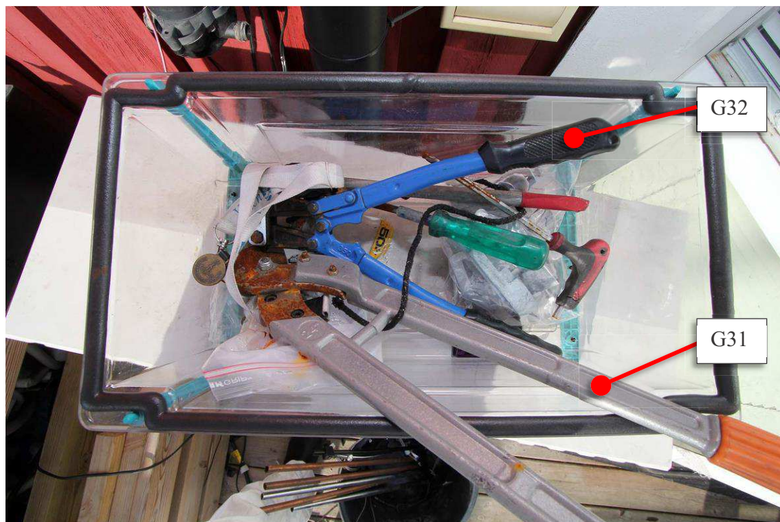
Figur 10 Kabelsaxen G31 och bultsaxen G32
