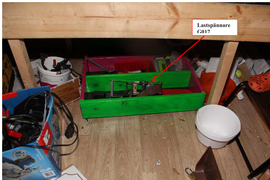
Bild 19. Lastspännare till spännband (G017).
