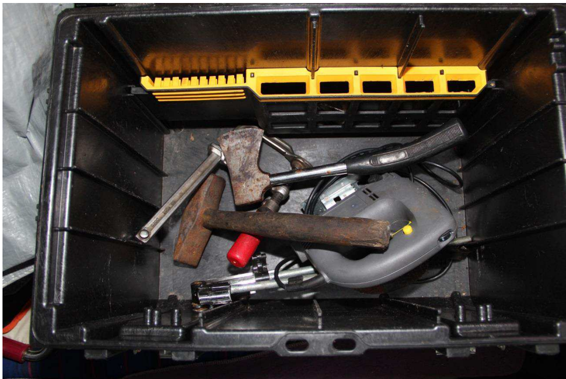
Figur 14 Verktygslådan med innehåll. Bl.a. yxhammaren G002 som hade fläckar vilka visade sig vara rost.
