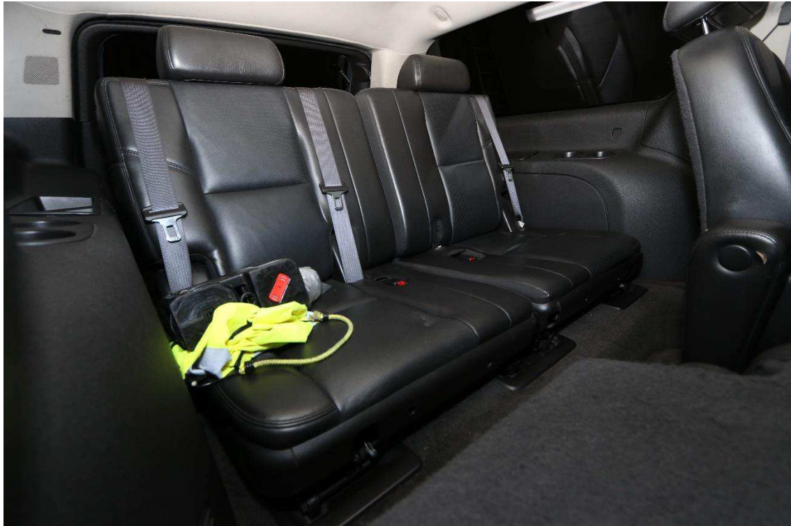
Figur 11. Tredje sätesraden. Föremål i säte efter att plastkåpa avlägsnats.
