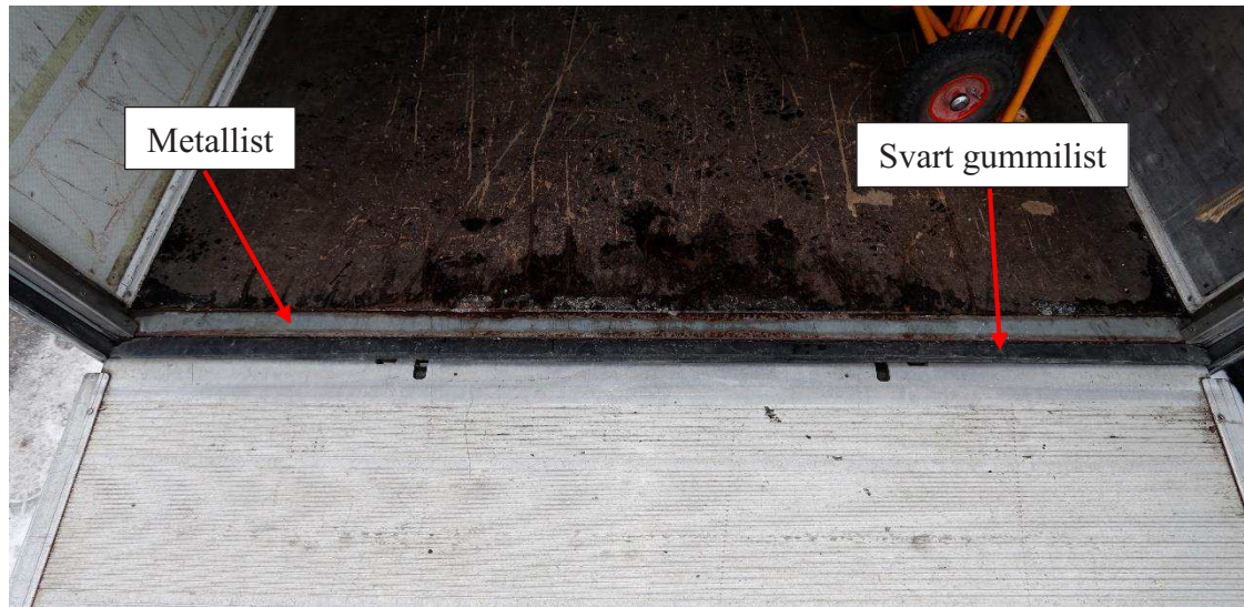
Figur 6. Metallisten och gummilisten mellan bryggan och lastutrymmet markerade.
