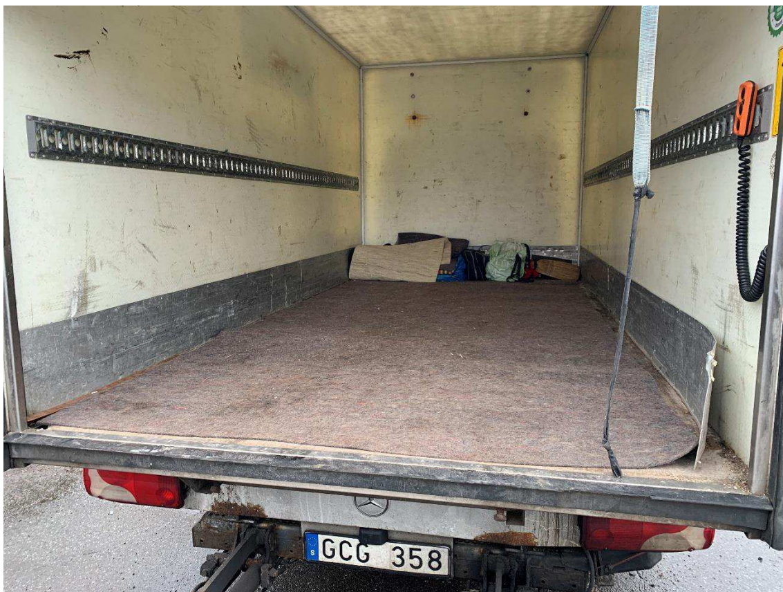
Figur 6. Lastutrymmet efter att filtmattan lagts ut.
