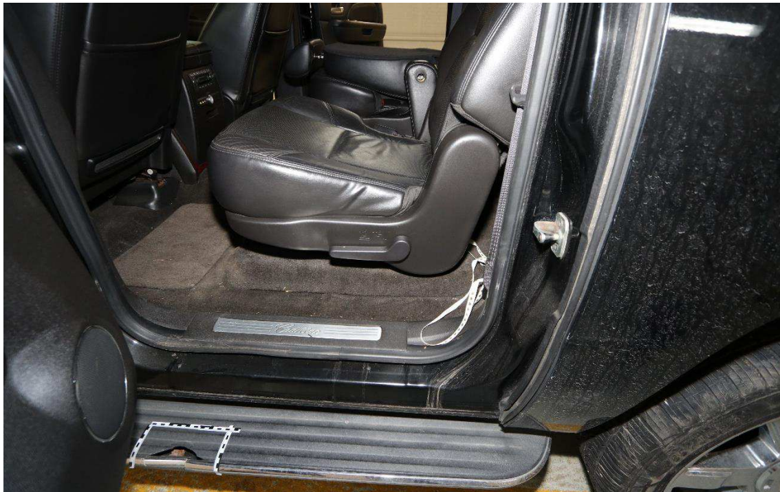
Figur 9. Baksäte, säkrat textilband (S265) och skada i instegslist.
