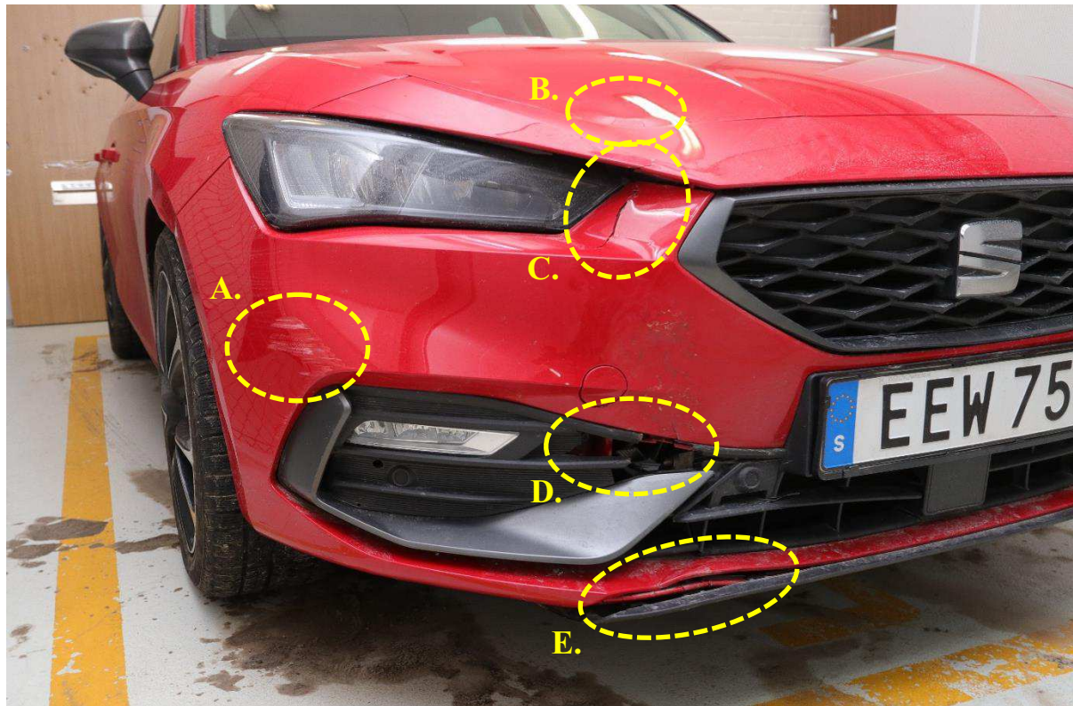
Figur 2. Pb EEW75E, skador höger fram. Skadorna är markerade med gula streckade ovaler. A: Horisontella repskador. B och C: Spricka i lack/plåt. D: Plastdetaljer spruckna och saknas. E: Deformerad plåt.
