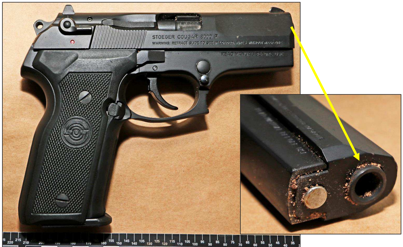
Figur 6. Pistol (G001) med magasin (G003). Den mindre bilden visar en förstoring, där det iaktogs någon form av sand/små gruskorn i och runt om pipans mynning.
