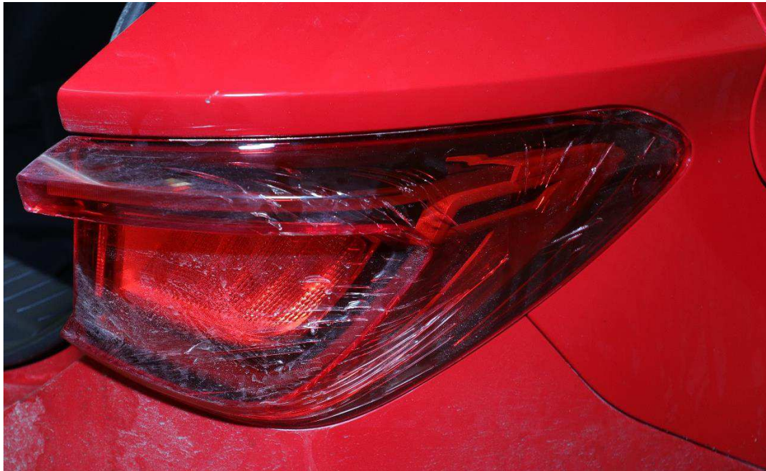
Figur 3. Höger baklykta. I lyktans plastmaterial kan en sprickbildning alternativt skiktning i materialet ses.
