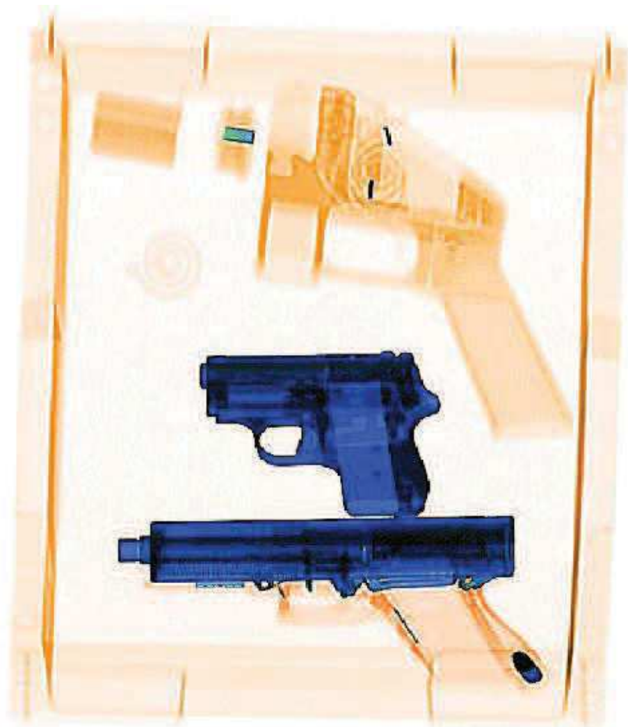
Figur 9. Röntgenbild av väska med tre vapen. Överst Liberator med tomhylsa i patronläget, i mitten en pistol helt i metall och underst en pistol med stomme i polymer. Foto: Niclas Bladh, NFC
