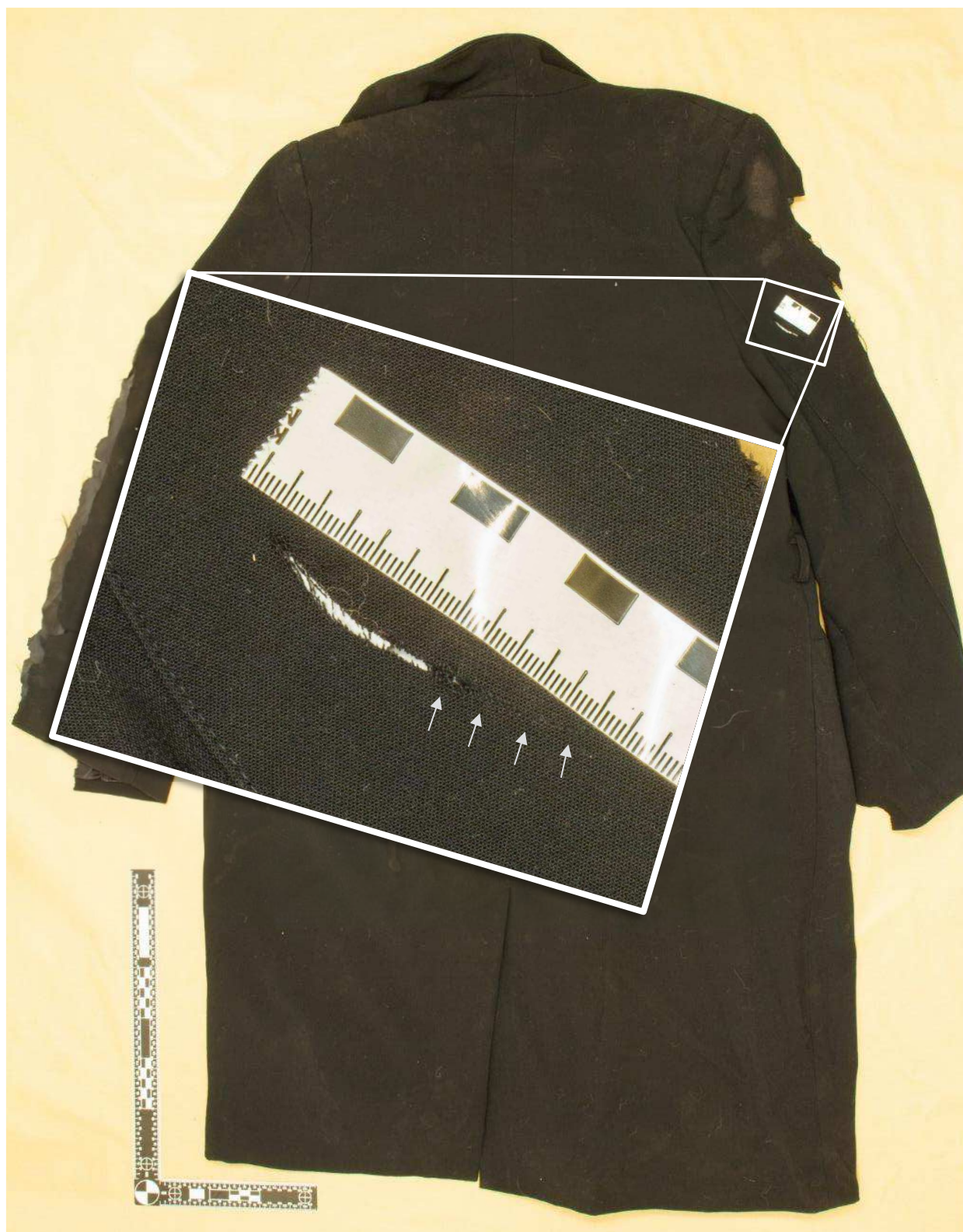
Figur 3 Detaljbild av skadan på höger axel. Ytlig rispa i den genomgående skadans förlängning (pilar).
