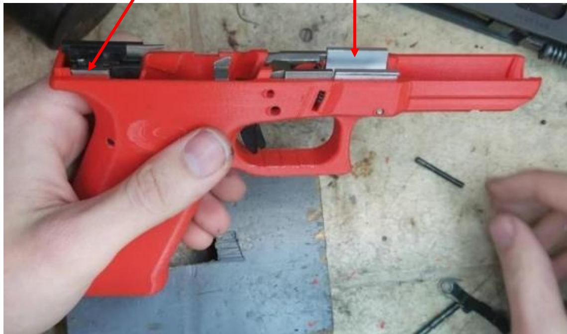
Foto nr 5, från internet visar placering av främre och bakre skenor på printade pistols stomme.
