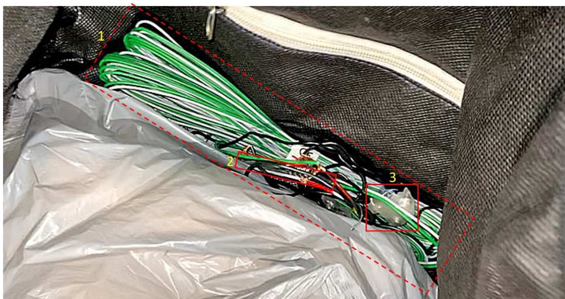
Bild 2: Detaljbild över elsprängkapsel och övrig elektronik i väskan.
