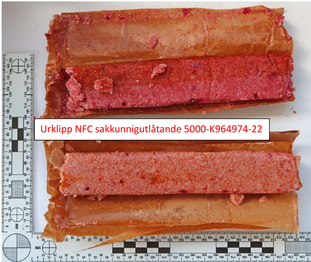
Bild 4: Den två dynamitstaverna i uppskuret skick.
