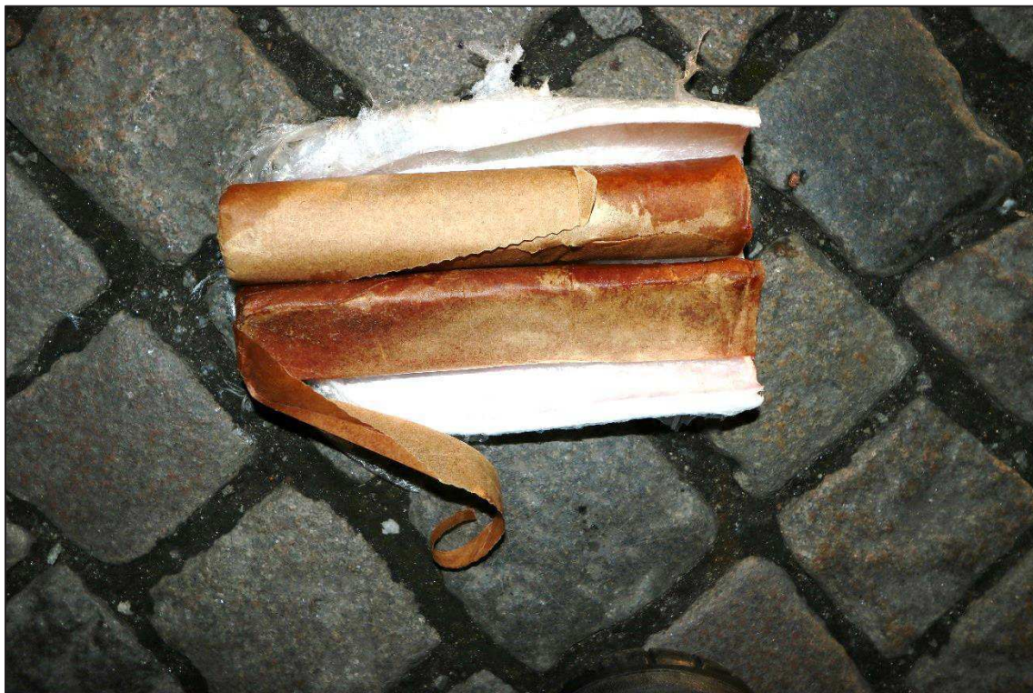
Figur 13. Stavar med explosivämne (G010) och plastfolie (G009).
