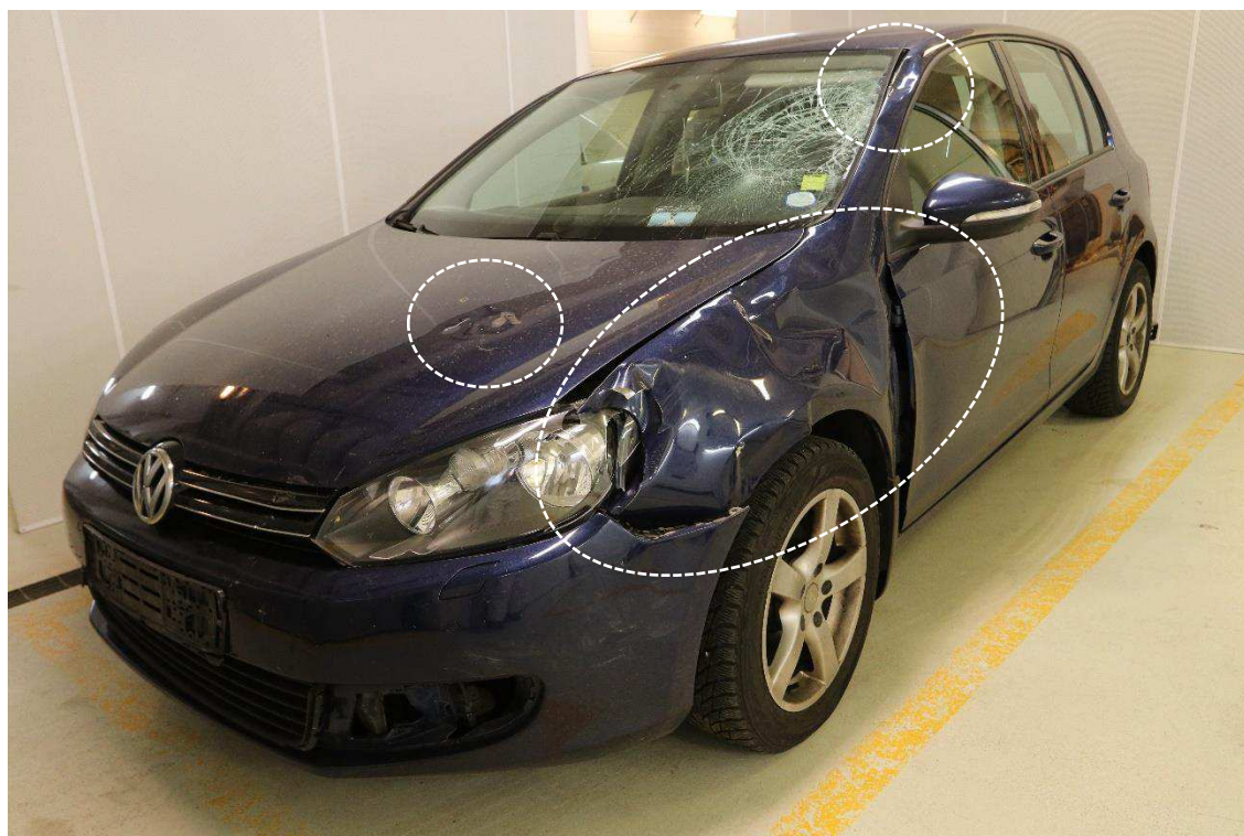
Figur 3. ERB851. Vita cirklar visar plåtskador som iaktogs på motorhuven och på vänster sida av personbilen.
