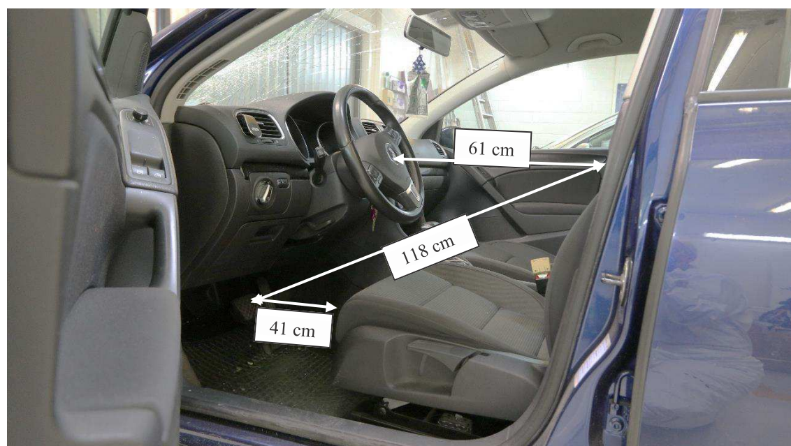
Figur 8. ERB851. Vita linjer med pilar visar ungefär passagerarstolens placering och avstånd fram till bromspedalen.
