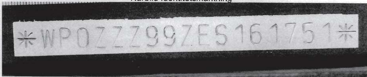
Närbild på identitetsmärkning när ytan tvättats med lösningsmedel, noterbart är att bara det absoluta närområdet är blankslipat från grundfärg
