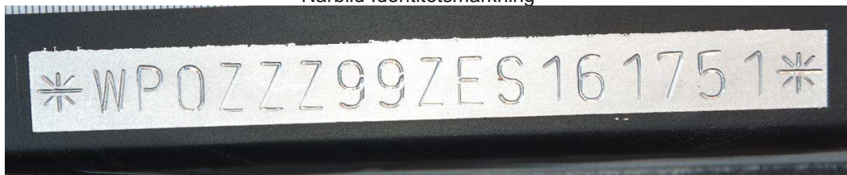
Närbild på identitetsmärkning när ytan tvättats med lösningsmedel, noterbart är att bara det absoluta närområdet är blankslipat från grundfärg
