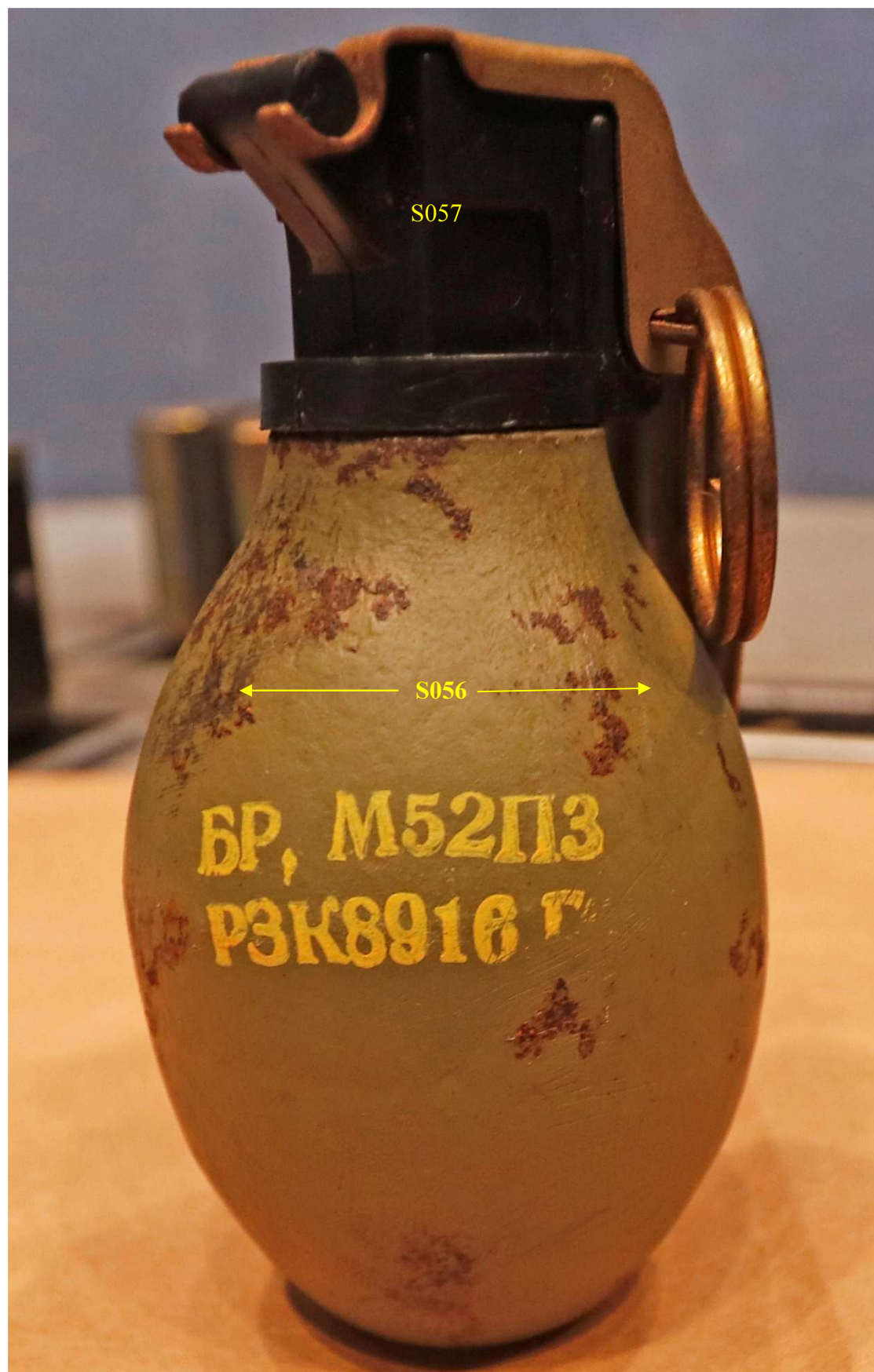
Figur 3. Handgranaten (G071). Kroppen spårsäkrades runt om. Plasthöljet (S057) på tändaren som spårsäkrades är markerat.
