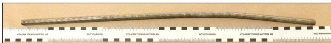
Figur 23 Gängstången är ca 60 cm lång och ca 8 mm bred
