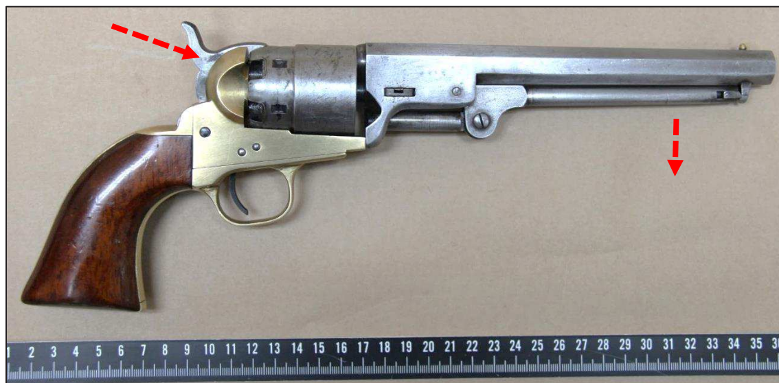
Figur 1 Revolverns högra sida. Hammaren (markerad) är fast. Avtryckaren är fast. Laddarmen som sitter under pipan går att frigöra och dra nedåt enligt markering.
