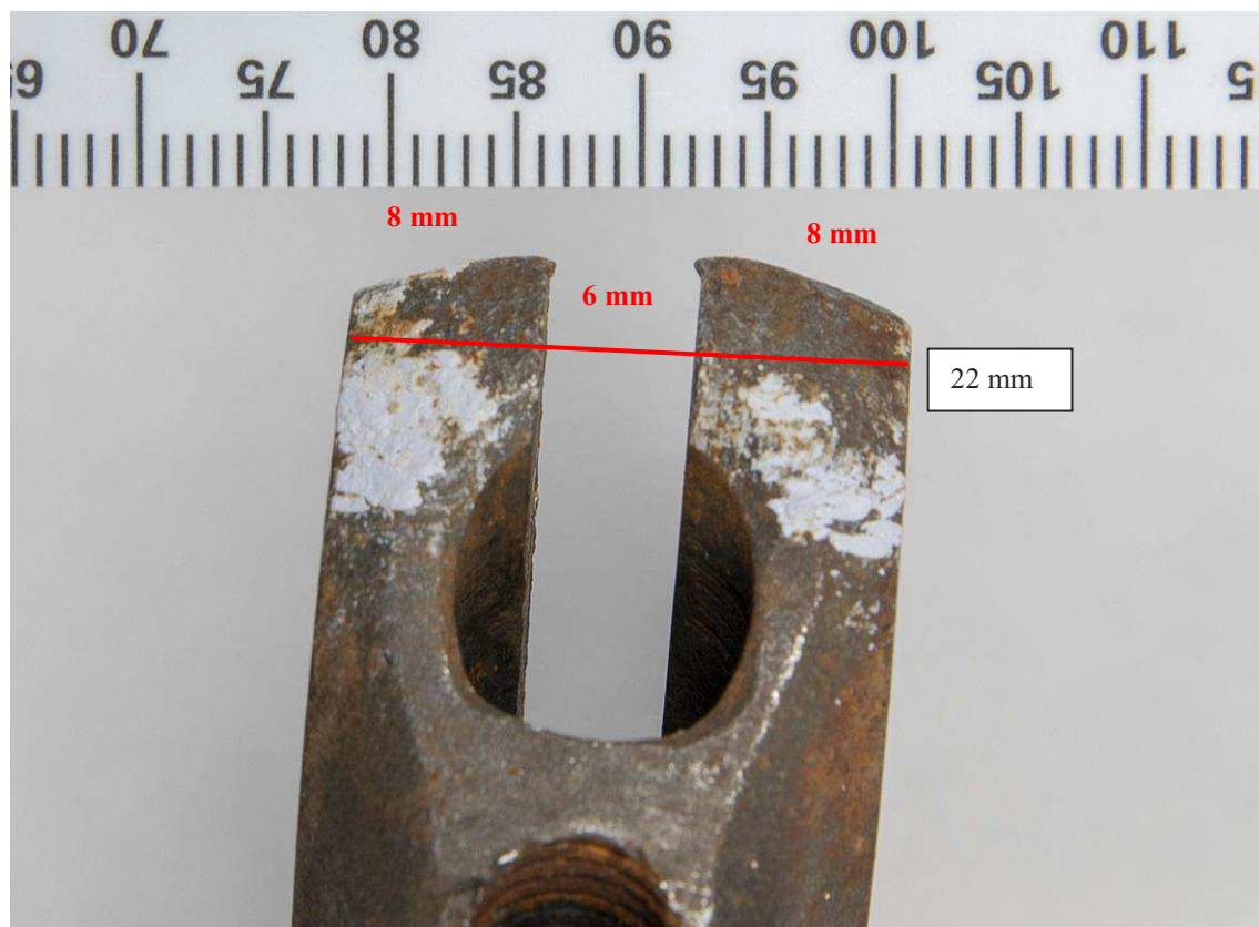
Bild 15 visar detaljbild på skiftnyckelns ena sida med måtten utsatta. (Bilden är spegelvänd.)
