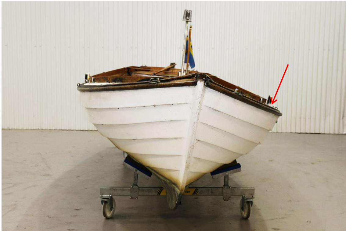
Bild 2 visar båten framifrån. Den lutar något åt det håll där tankens öppning är placerad (pilen).
