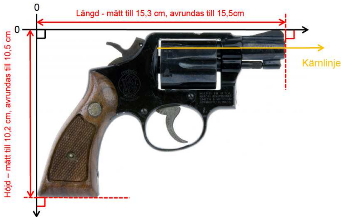
Bild 2: Exempel, mätning av vapens längd och höjd - revolver
