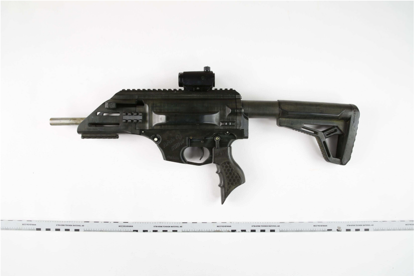
2. Ett egentillverkat 3D-utskrivet skarpt halvautomatiskt skjutvapen av modell FGC-9 Mk2 (BG122428-1)
