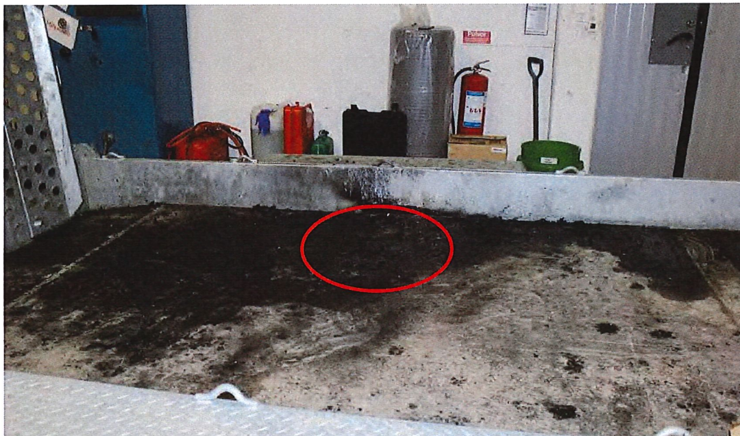
Figur 5. Röd oval markerar brandskadat/kolat område på släpet varifrån S070-S073 säkrades.
