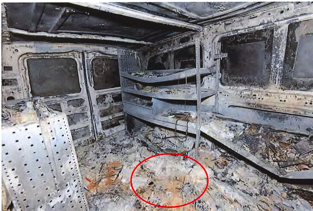
Figur 5. Den utbrända skåpdelen. Från golvet säkrades kolbitar samt material för analys avseende brännbar vätska. Röd oval markerar varifrån material. S104, för brandprov säkrades.
