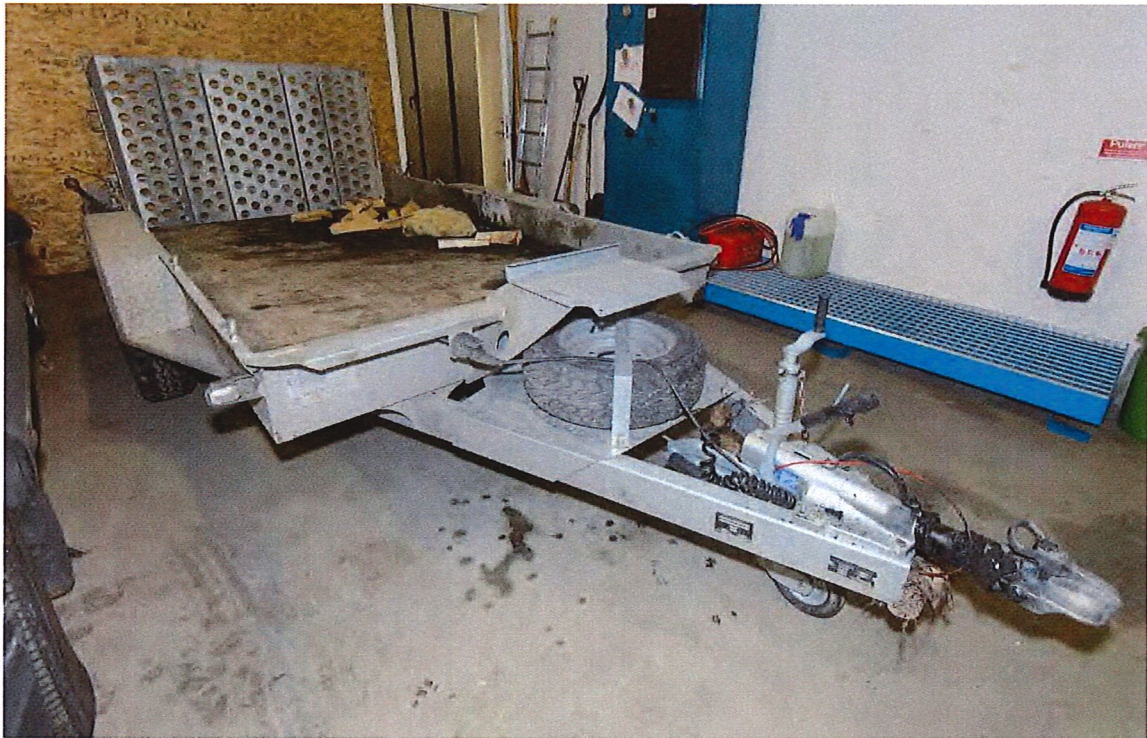
Bild 1. Släpvagn ZLR 421 uppställd i polisens garage. Brandskador fanns på dragstången framtill och på en del av släpets golv.
