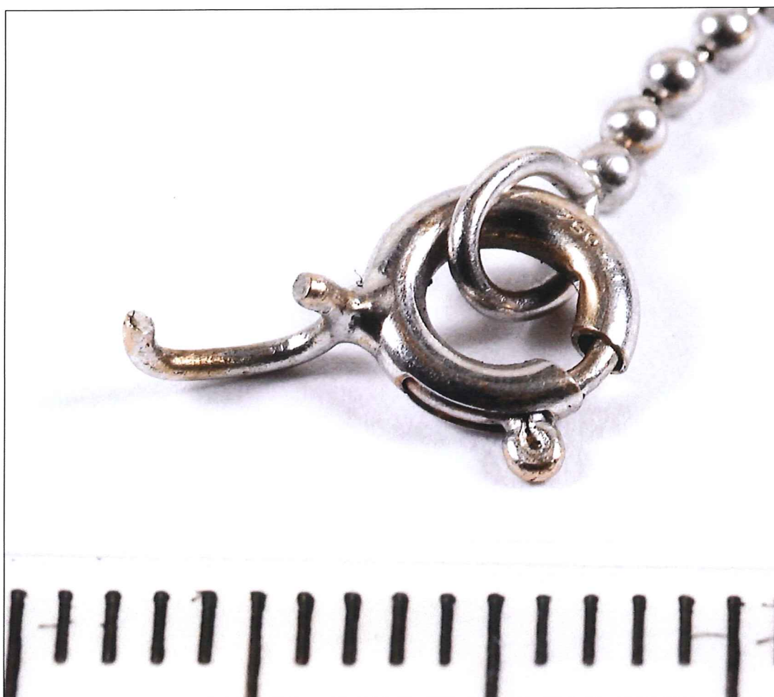
Foto 27. Detaljbild på den skadade länken. Måttskalan med millimeterskala ligger i bildens nederkant.
