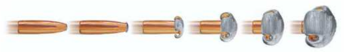
Figur 2 Oryxkulan expansion i målet. bild från www.norma-ammunition.se
