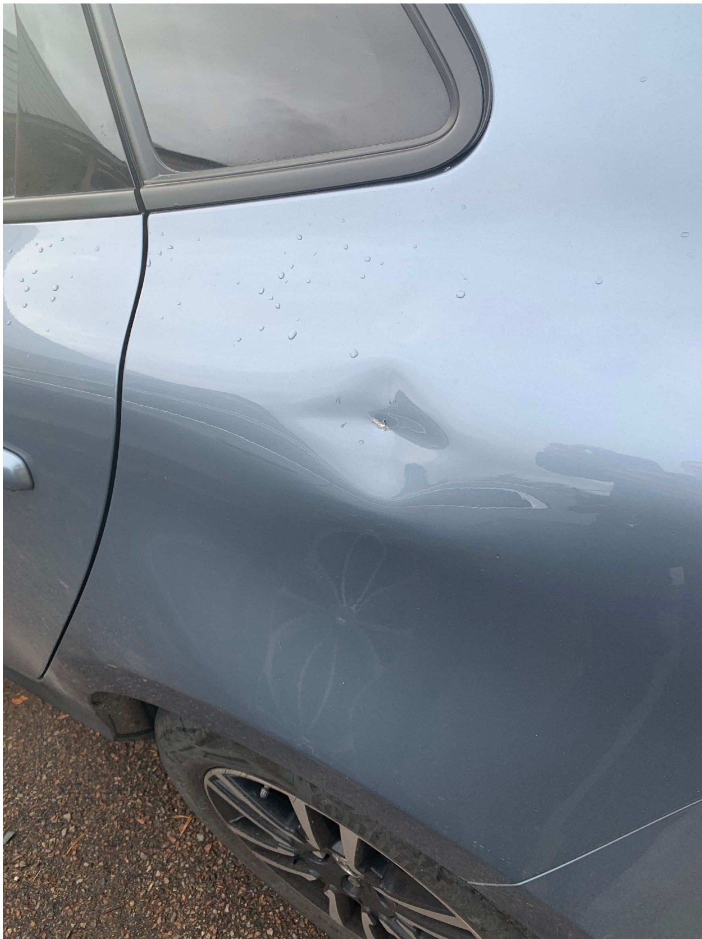
4. Skada på vänster bakskärm.
