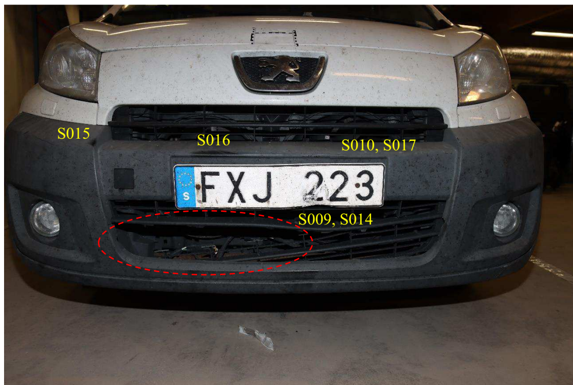
Figur 5. På registreringsplåten fanns en skada i form av en inbuktning/buckla och avsaknad av färg (S009, S014). På kofångaren ovanför registreringsplåten iaktogs skrapmärken (S010, S015-S017).
