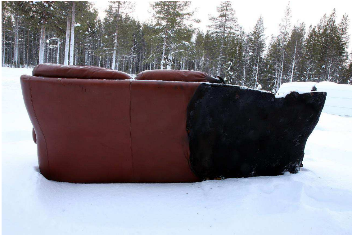
Bild 7. Soffans bakstycke med det brända området till höger i bild.
