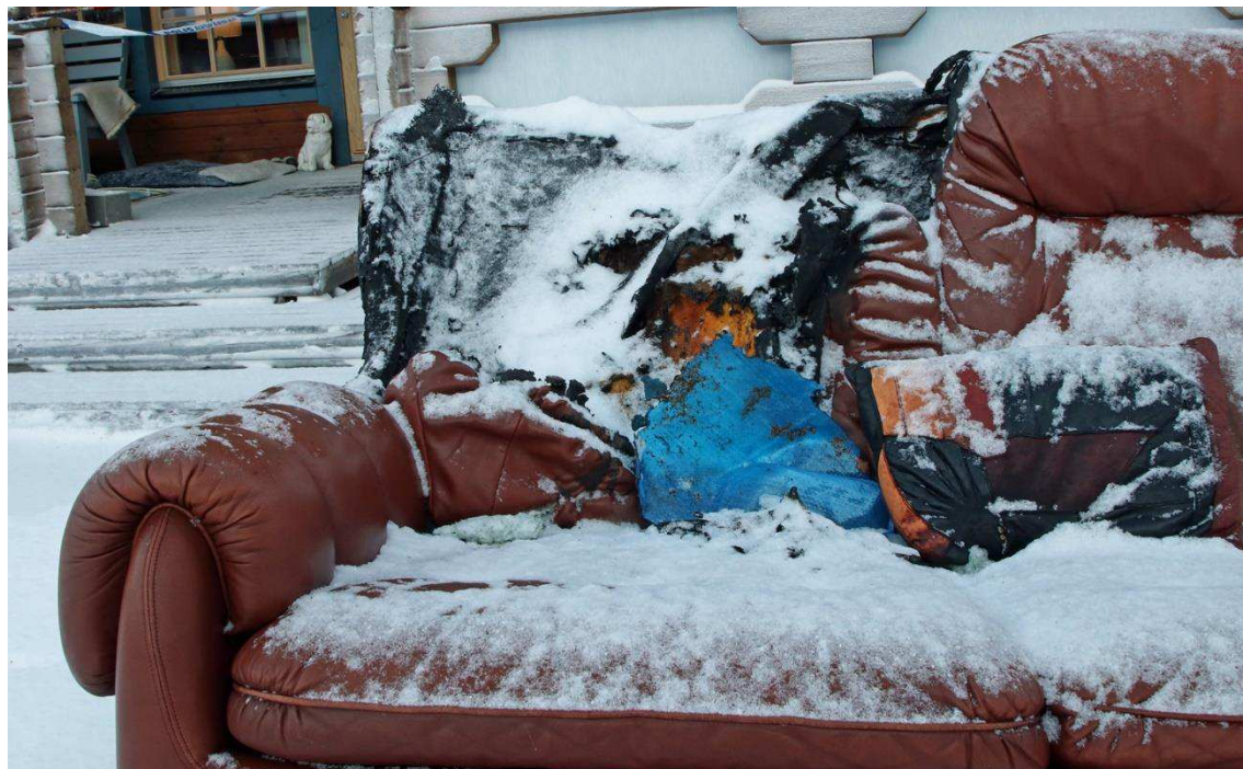
Bild 5. Soffans vänstra sida med brandskador på övre delen av ryggdynan.
