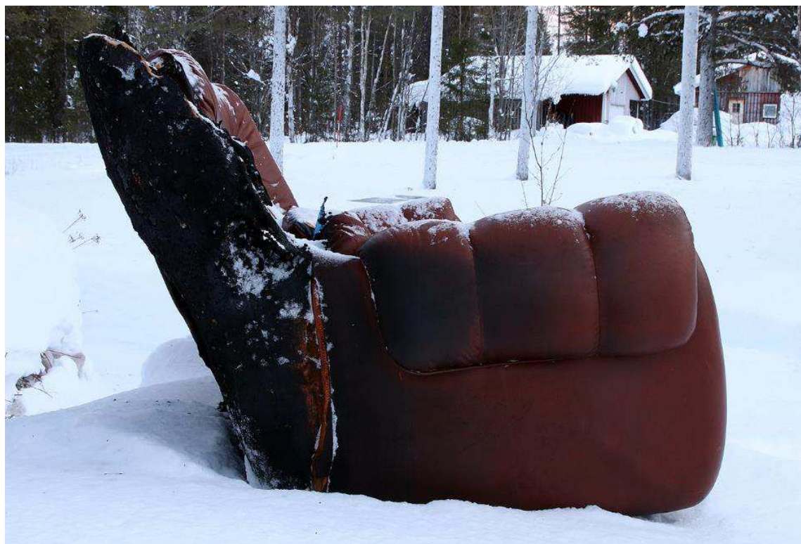
Bild 6. Soffans vänstra sida med brandskador på sidan och ryggsidan.
