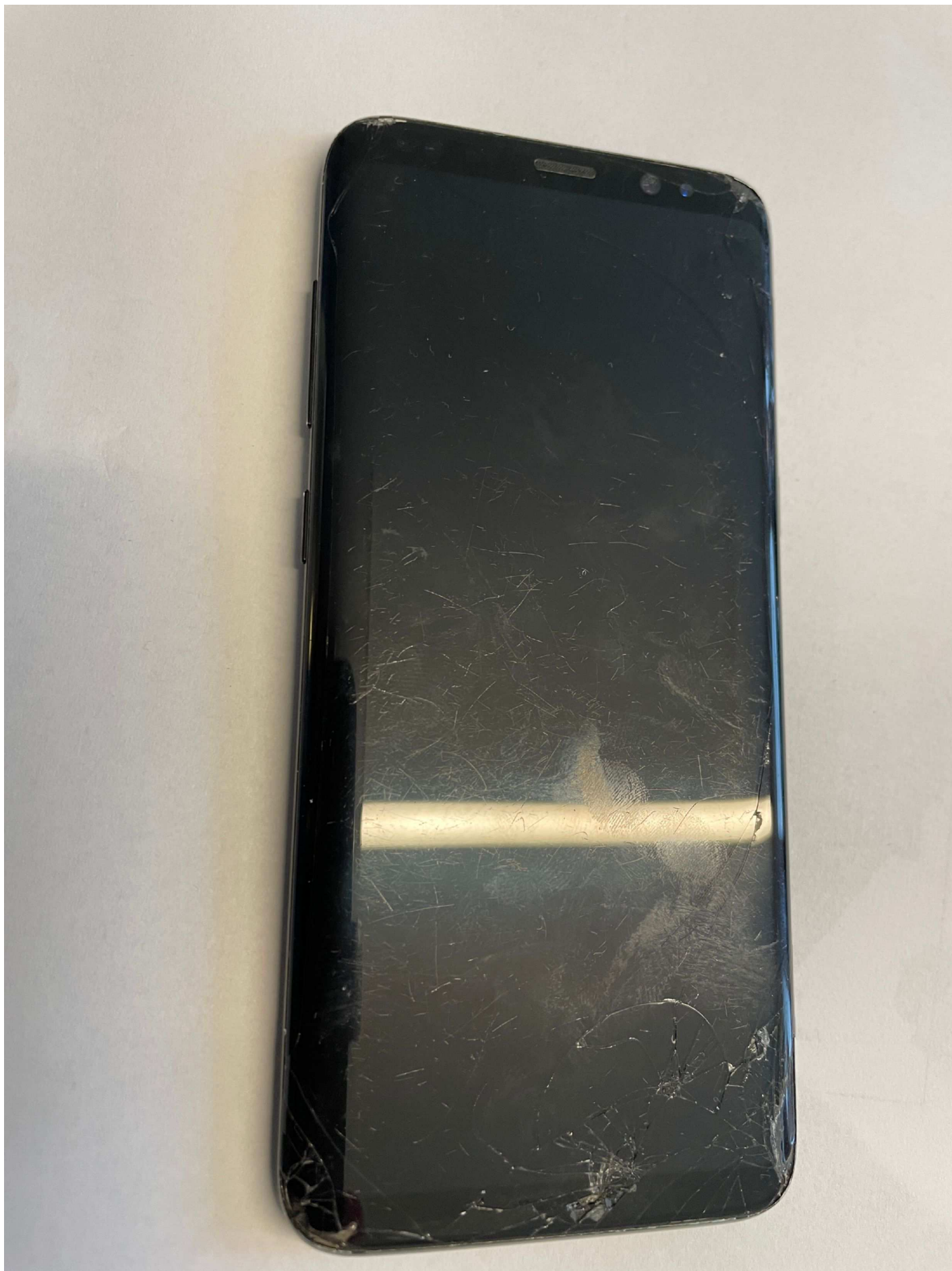
1. Bg102961-1. Sprickor på glasskärm framsida. Pa.Stenström
