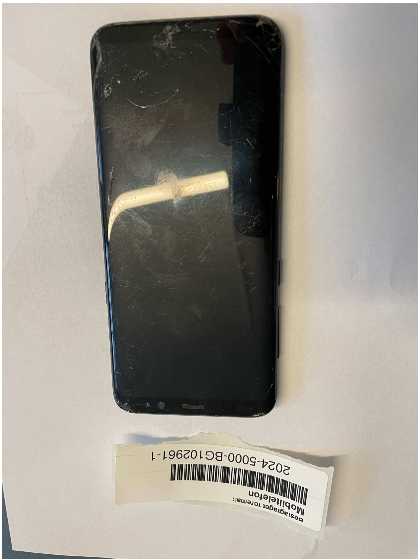
2. Bg102961-1. Sprickor på glasskärm framsida. Pa.Stenström
