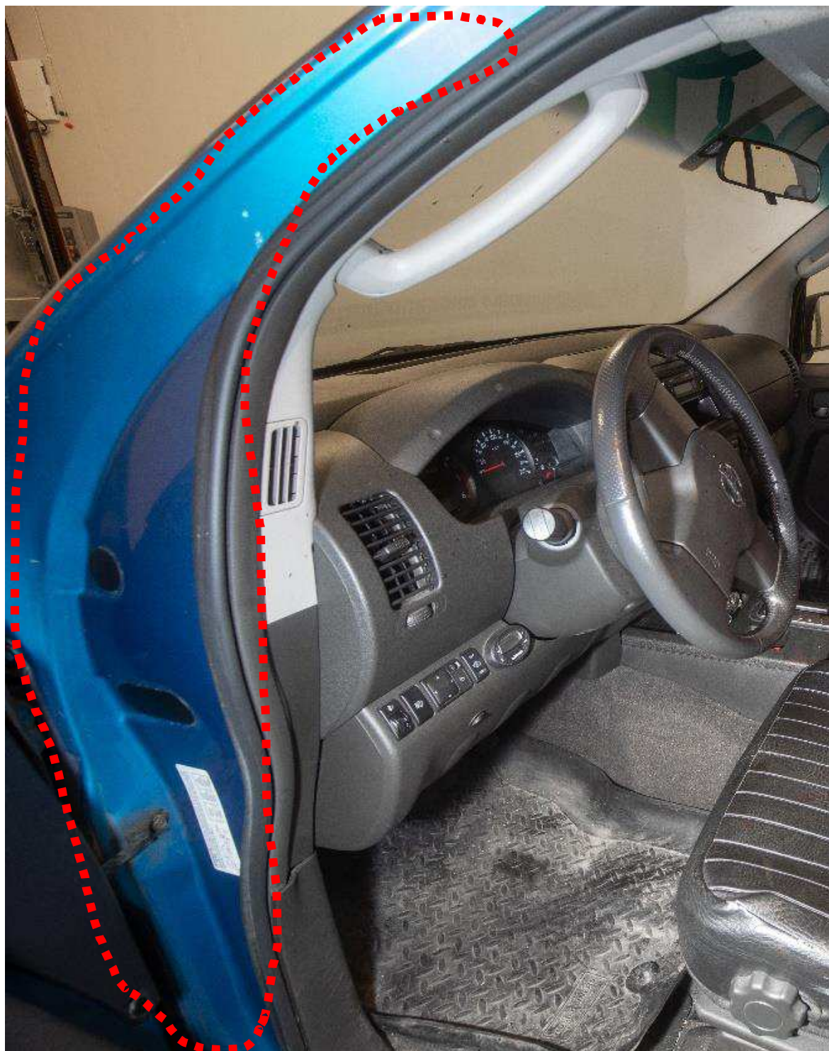
Figur 6. Förardörrens A-stolpe när förardörren är öppen. Röd markering visar plåten på A-stolpen.
