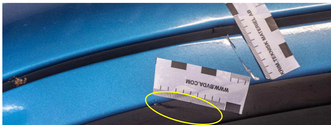
Figur 20. Närbild visar övre delen av fönstret. Gul oval markerar skadan i plastdetaljen och hålet i plåten på förardörrens övre del.
