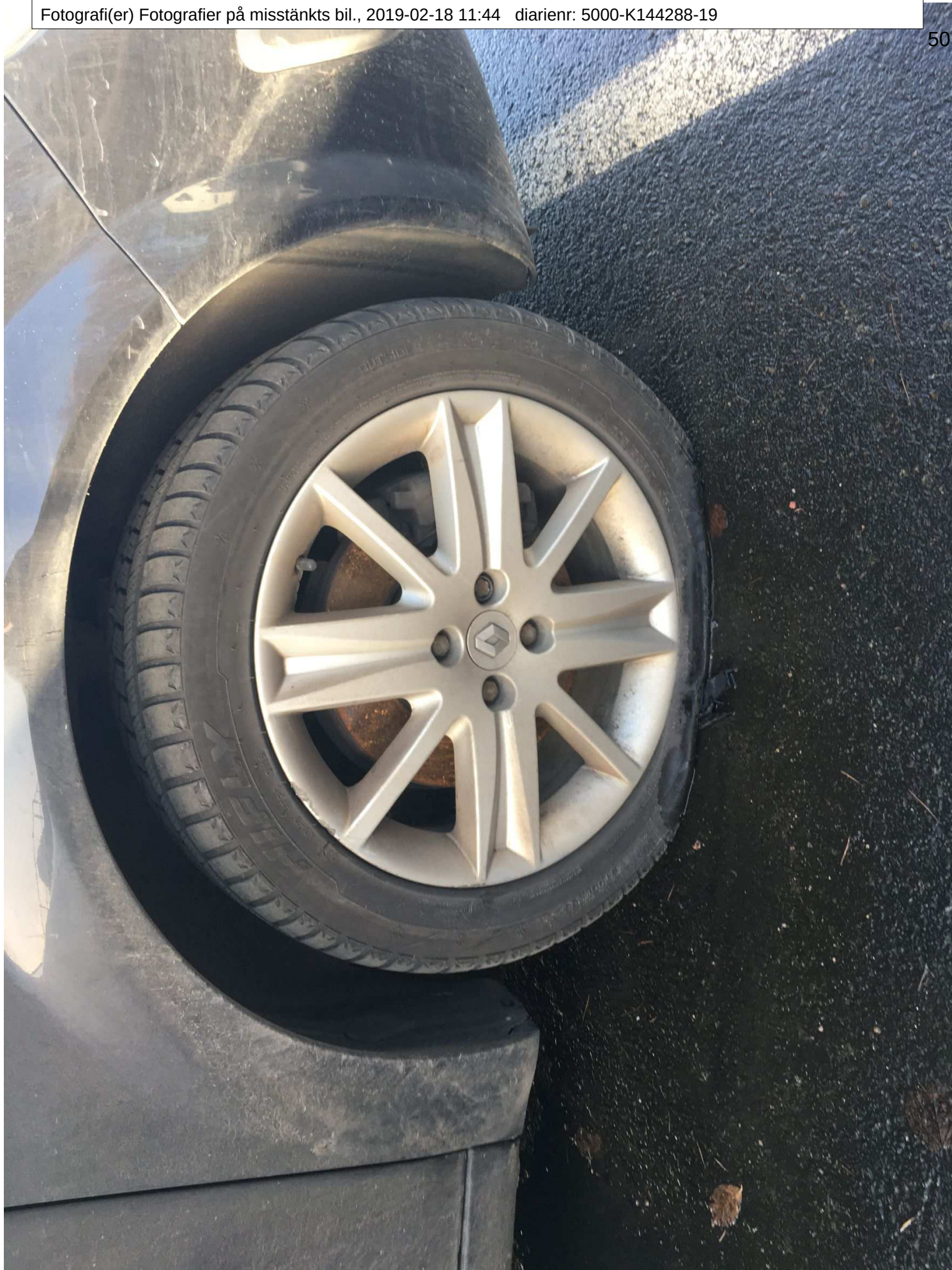
Höger framhjul är utan luft.
