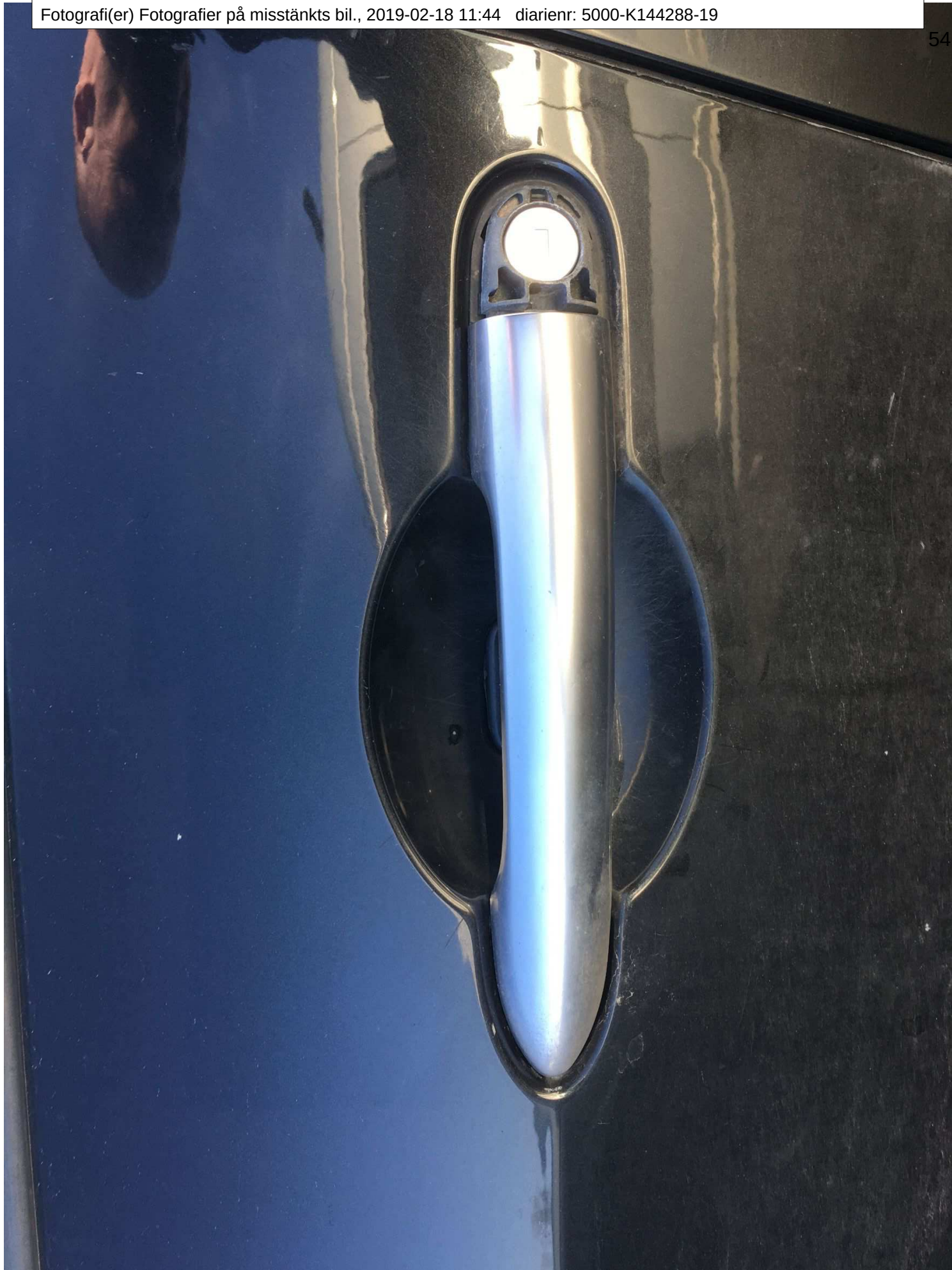
Lock saknas till dörrlås på förarsidan fram.
