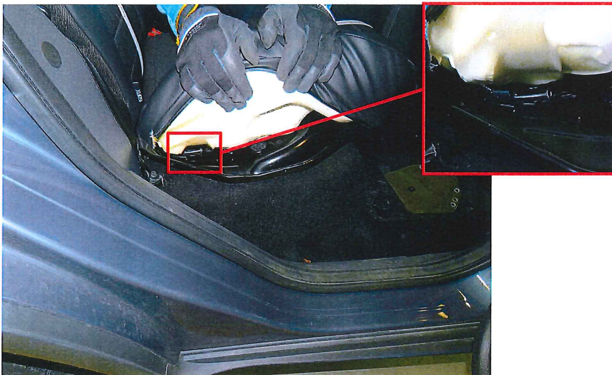
Bild 43. De bakre sätena var fastsatta med en böjd skruv och inte med för bilen originalinfattning, se förstoring.
