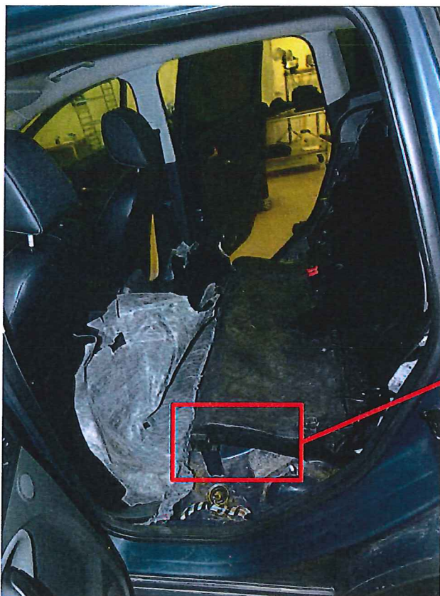
Bild 46. Stommen till baksätet för bilen var inte original. Se sprängskiss nedan.
