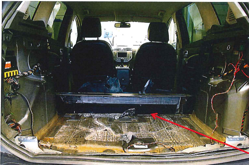
Bild 38. Bagageutrymme vid spårsökningstillfälle. Lucka till lönnutrymme samt baksäte är bortmonterat. Delar av lönnutrymmet går in under baksätet. Utrymme under baksätet är original för bilens utförande dock kan baksätet i den undersökta bilen vara höjt något, se bild 42.
