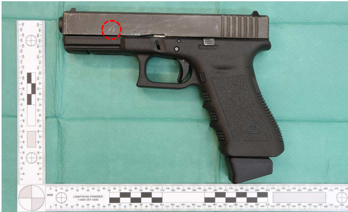
Figur 11. Den tillvaratagna pistolen med magasin. Likheten med skrapmärkena på mantelns vänstra sida i figur 10 är markerad.
