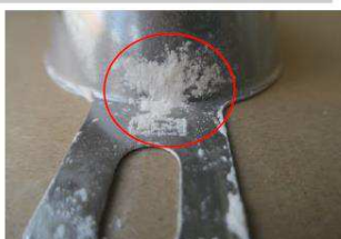
Undersökt pulveravsättning. Markering visar varifrån prov har säkrats för analys
