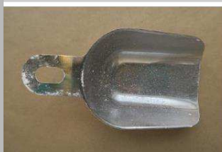
Pulveravsättningar på skopans handtag
