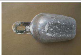
Pulveravsättningar på skopans baksida
