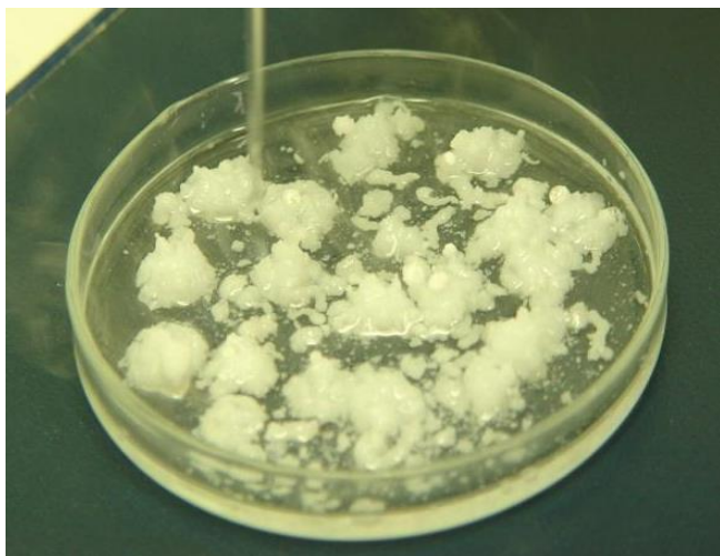
Bild 6. Alltmer pulver bildas vid svavelsyratillsats.
