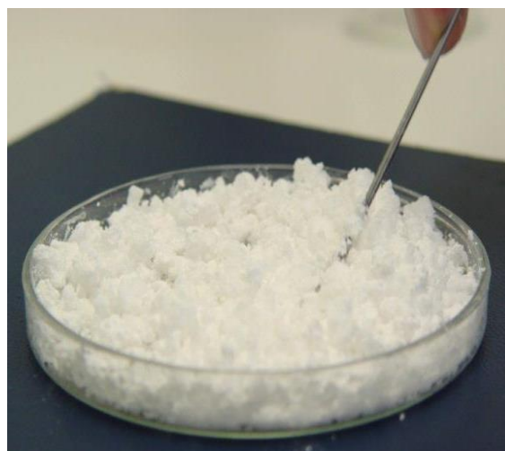
Bild 7. Utfällningen av pulver är klar. Överskottet av lösningsmedel kan antingen avskiljas med filtrering eller får dunsta när pulvret torkas.
