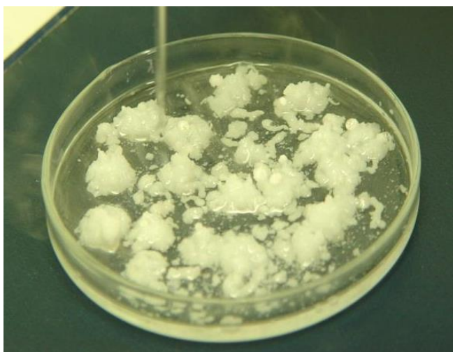
Bild 6. Alltmer pulver bildas vid svavelsyratillsats.
