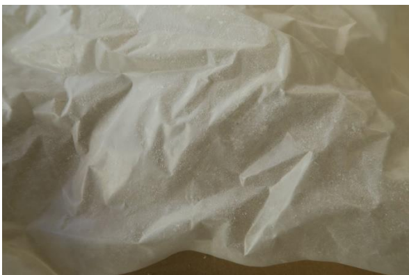
Vidhäftat pulverdamm på andra sidan av plastsäcken
