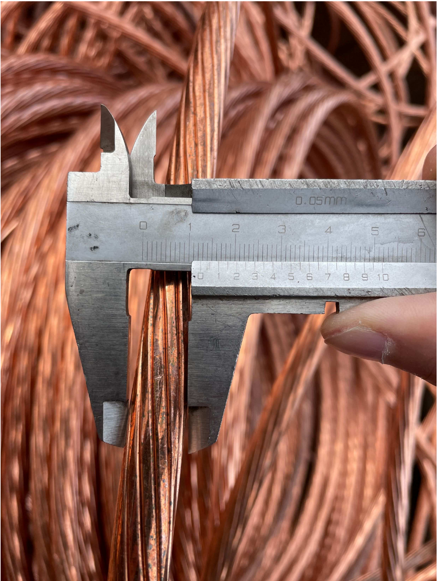
7. Mätning av diameter på kopparlina. (12,7 mm). Fotat på Kuusakoski.
