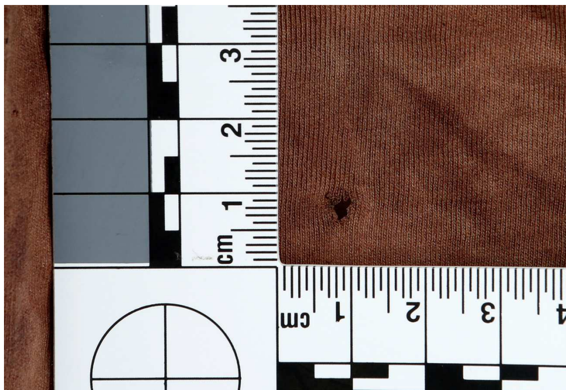
Figur 4. Närbild på skada B i figur 2, med fransiga kanter.
