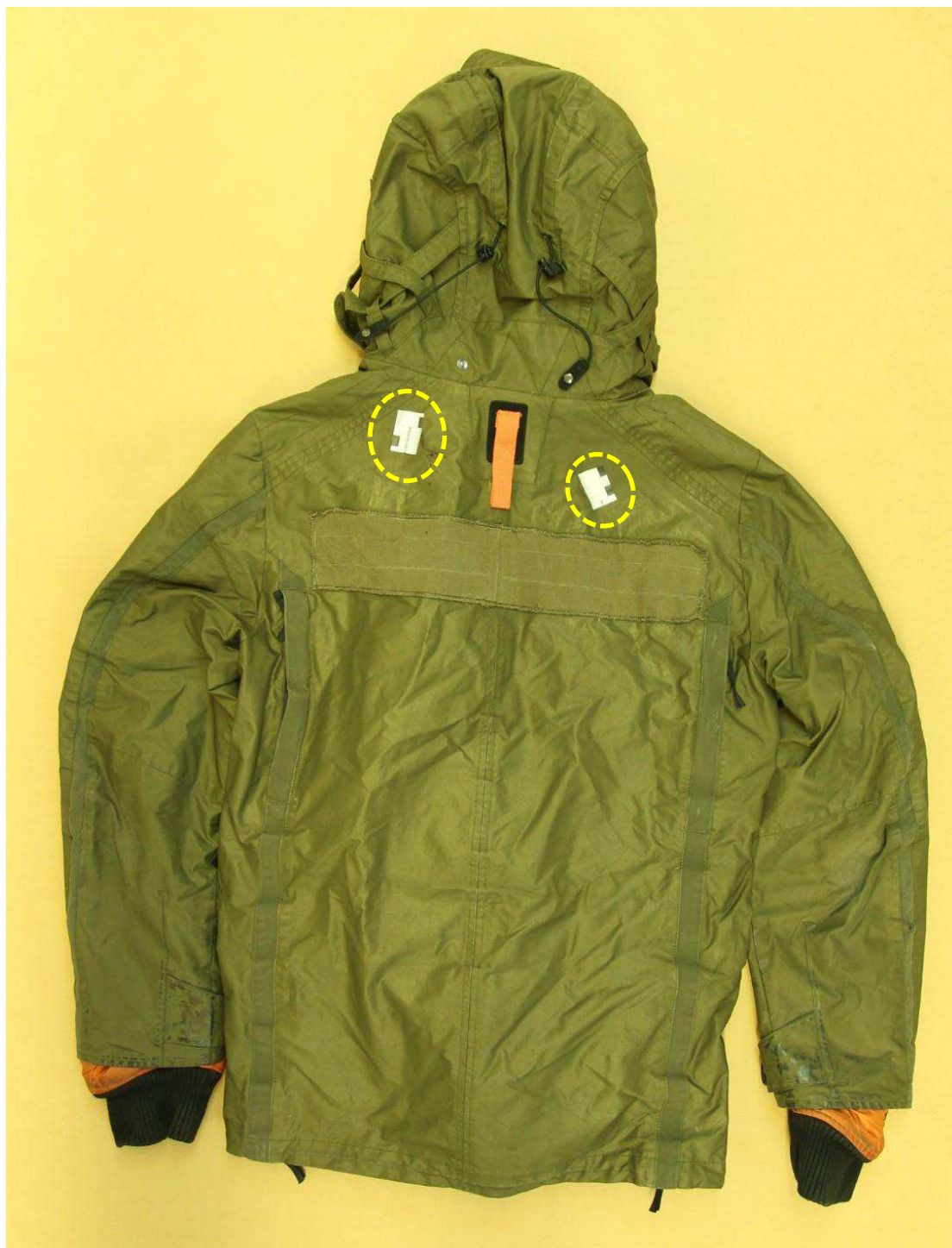
Bild 4. Bakstycke, jacka. Skadornas placering uppmärkta med millimetertejp samt oval ring.
