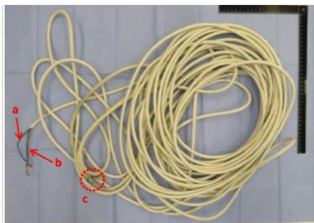
a: blå kabel och tvinnad ände, b: brun kabel och tvinnad ände c: tre färgade kablar och tvinnade ändar inne i det streckade området.
