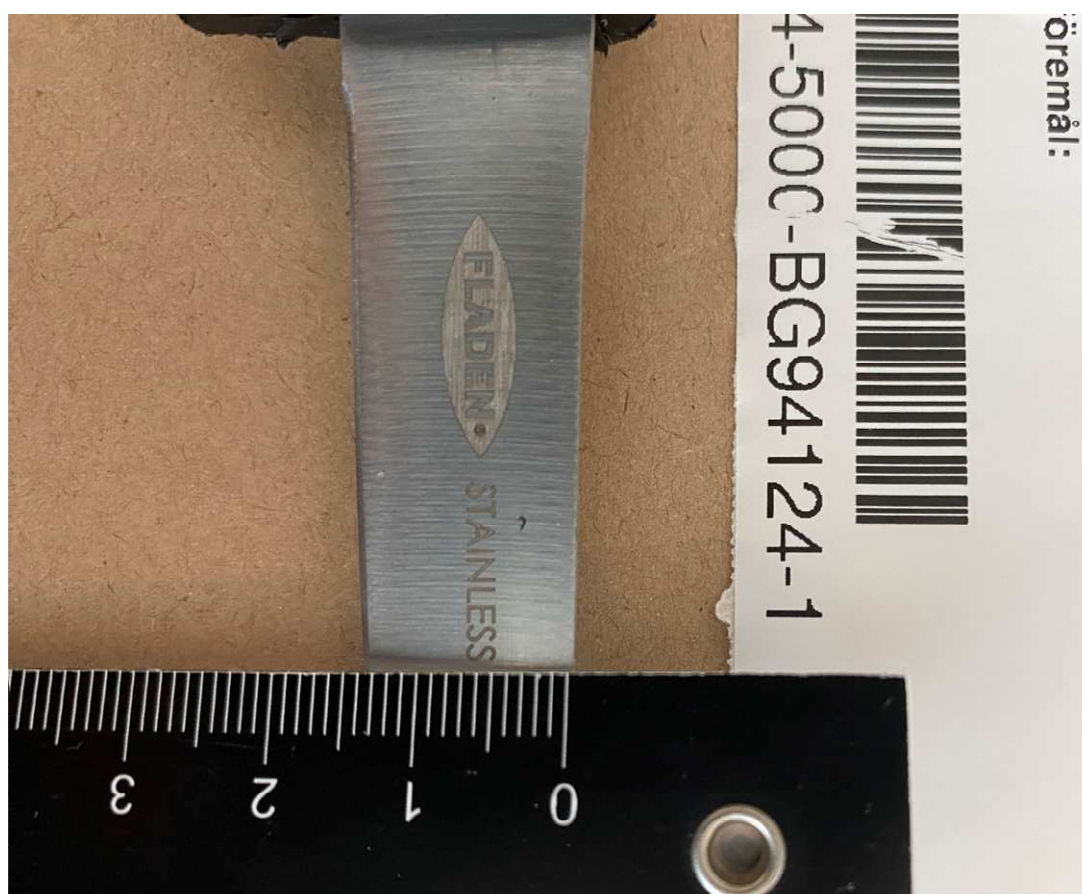
Figur 5. Mått på bladets bredd. 13 mm på mitten och avsmalnande.
