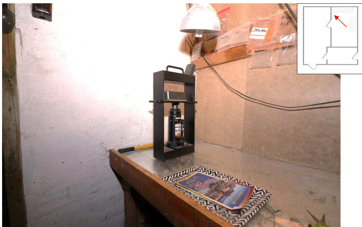
Figur 10. På arbetsbänken stod en domkraftspress som hör ihop med pressverktyget 2022-5000-BG12348-13.
