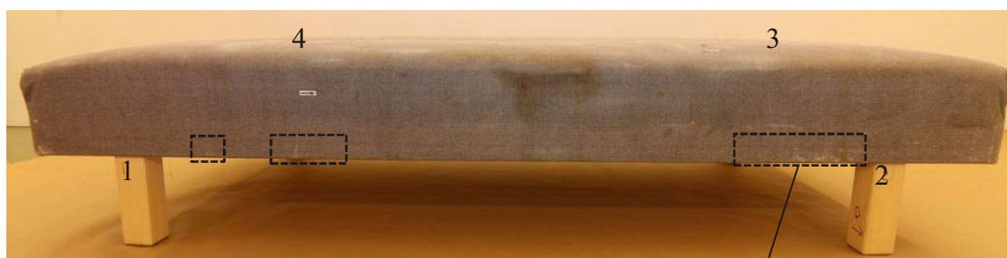
Figur 22. Sidan som stod ut mot rummet. Förslitningsskador har markerats intill sängbenen 1 och 2.
