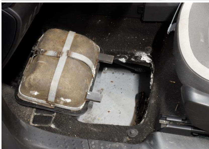
Bild 14-16. Golvet vid vänster framsäte. Under golvmattan finns en lucka till ett förvaringsutrymme. Hela facket kan lyftas upp och under det finns ett utrymme som inte ingår i originalutförandet. Påsvetsade förstärkningar och metallbitar på undersidan av förvaringsfacket är inte heller original.
