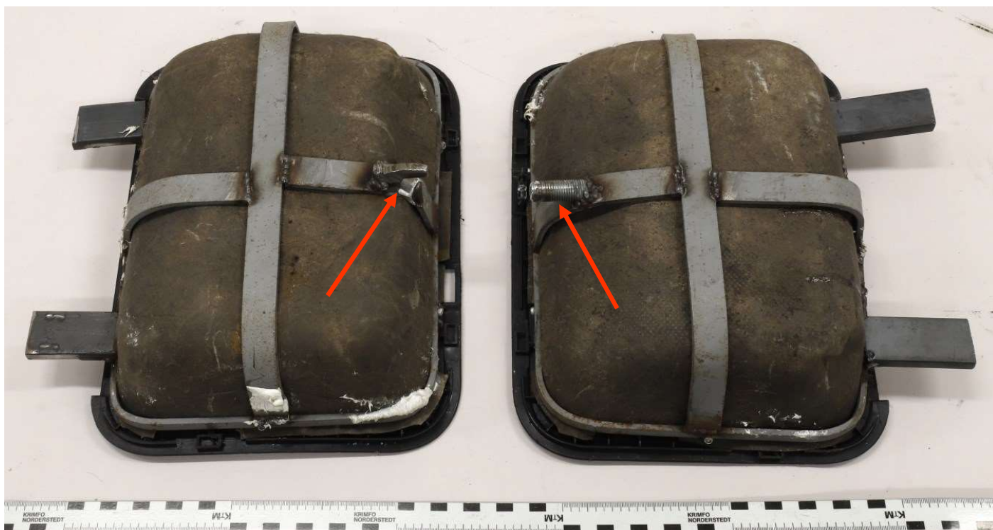
Bild 18. Undersidan av facken i vänster respektive höger golv. Påsvetsade metallpiggarna motsvaras av låsens placering när facken är på plats i bilens golv. Piggarna är menade att tryckas ner i låsmekanismerna och facken hålls då på plats.
