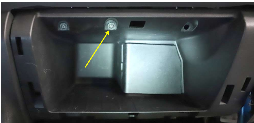
Bild 20. Den yttre ramen till handskfacket bortmonterad. Under denna ses den skruv som ingår i upplåsningsmekanismen till det vänstra lönnutrymmet (gul pil).
