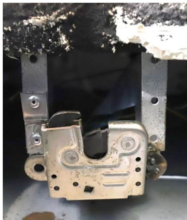
Bild 17. I de dolda utrymmena i golven sitter en låsmekanism som har kunnat hålla förvaringsfacken på plats. Mekanismen på höger sida i fordonet fungerar inte längre men det är oklart om den gjort det vid beslagstillfället. Mekanismen på vänster sida fungerar dock. Sladdar går från låsen upp till handskfacket (se vidare bild 19-21).
