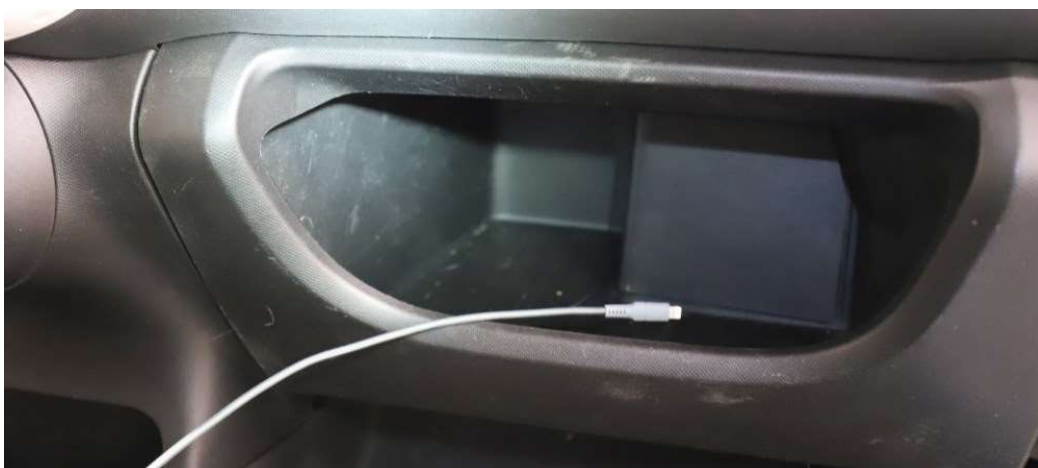
Bild 19. Bilens handskfack. I 12-voltsuttaget i bilens mittkonsol sitter en laddsladd. När sladdens ände nuddar en av skruvarna som håller fast handskfacket låses den vänstra låsmekanismen upp (se bild 20-21 samt film).
