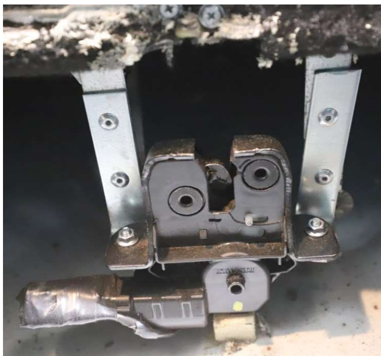
Bild 17. I de dolda utrymmena i golven sitter en låsmekanism som har kunnat hålla förvaringsfacken på plats. Mekanismen på höger sida i fordonet fungerar inte längre men det är oklart om den gjort det vid beslagstillfället. Mekanismen på vänster sida fungerar dock. Sladdar går från låsen upp till handskfacket (se vidare bild 19-21).
