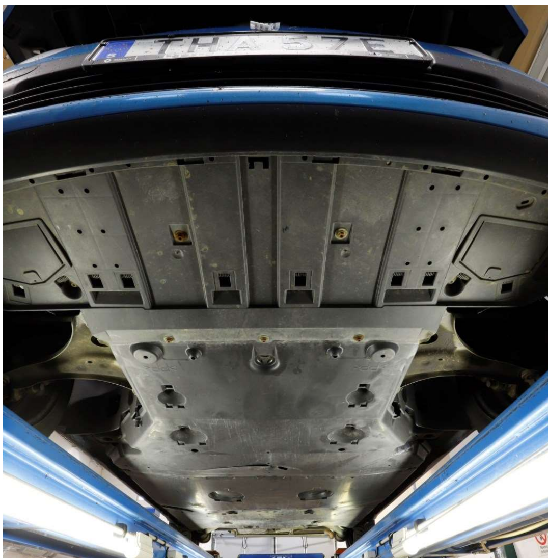
Bild 23. Fordonets underifrån med skyddsplastkåpor längs hela underredet. Dessa sitter lite löst och flera skruvar saknas.
