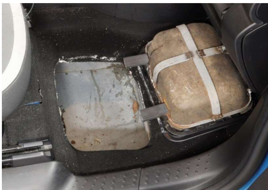
Bild 11-13. Golvet vid höger framsäte. Under golvmattan finns en lucka till ett förvaringsutrymme. På undersidan av luckan säkrades papillarlinjespår S001-S002 . Hela facket kan lyftas upp och under det finns ett utrymme som inte ingår i originalutförandet. Påsvetsade förstärkningar och metallbitar på undersidan av förvaringsfacket är inte heller original.
