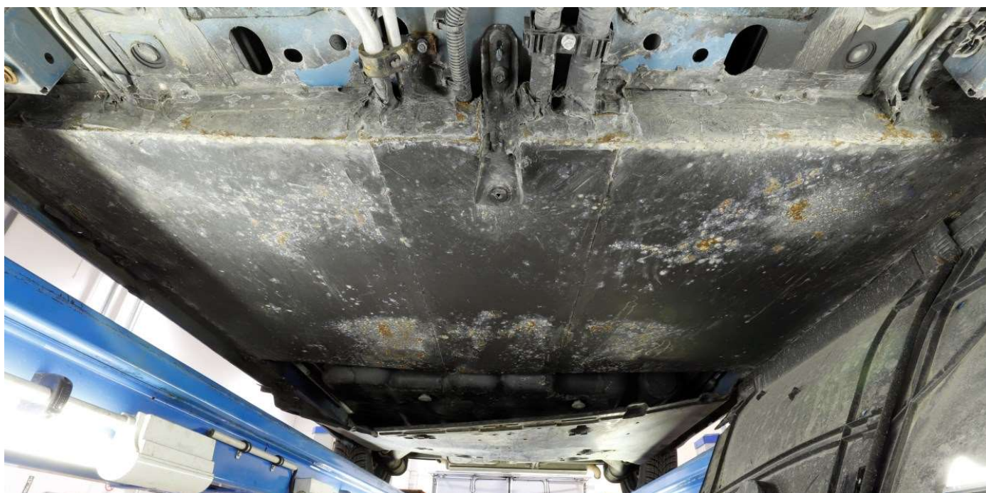
Bild 25. Lönnutrymmet täcker hela bilens bredd och mäter ca 70*120cm i yttermått, med ett djup på ca 8cm. Invändigt är utrymmet avdelat på mitten mellan höger och vänster sida av bilen.
