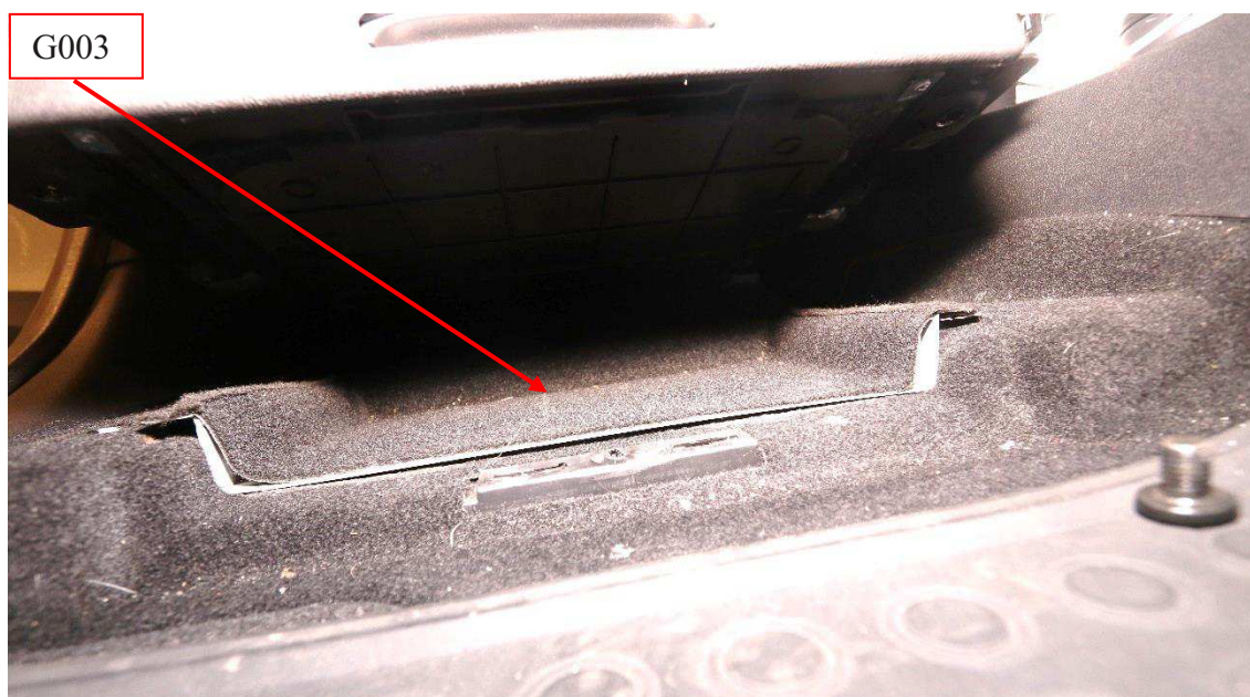
Figur 16: Visar luckan (G003) i golvet under passagerarsätet fram.
