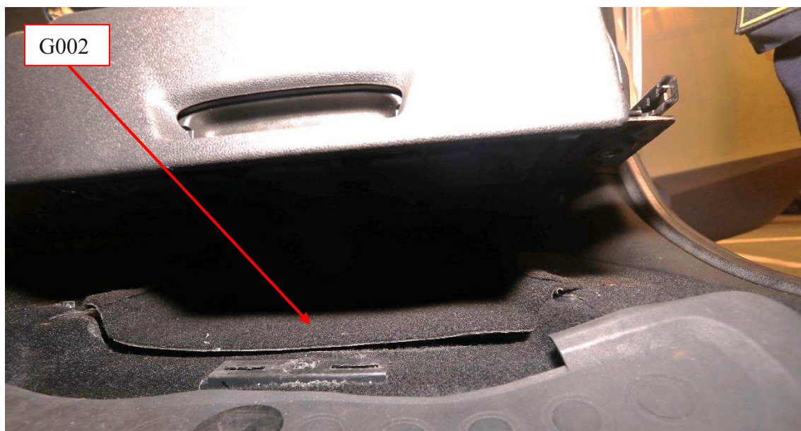
Figur 10: Visar luckan (G002) i golvet under förarsätet.
