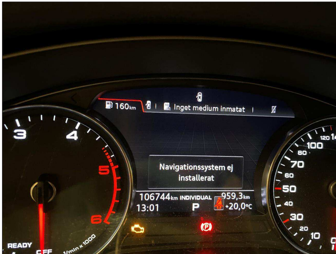
Figur 1, foto på fordonets instrumentpanel efter att undertecknad tryckt på knappen "NAV" på ratten.
