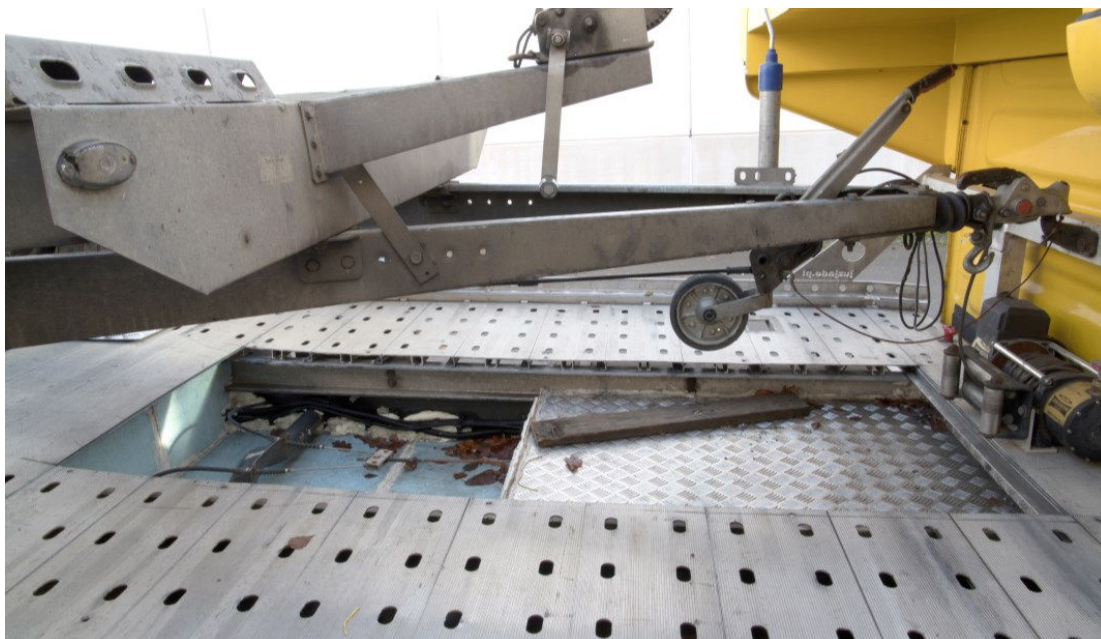
Bild 9. Golvet på lastrampen bakom förarhytten med ett nedsänkt utrymme under golvet. Täckplåtar och plåtribbor som täckt hålet har avlägsnats vid beslagstillfället (se även bild 15-17 samt jämför med bilder från kontrollgruppens bildspel).
