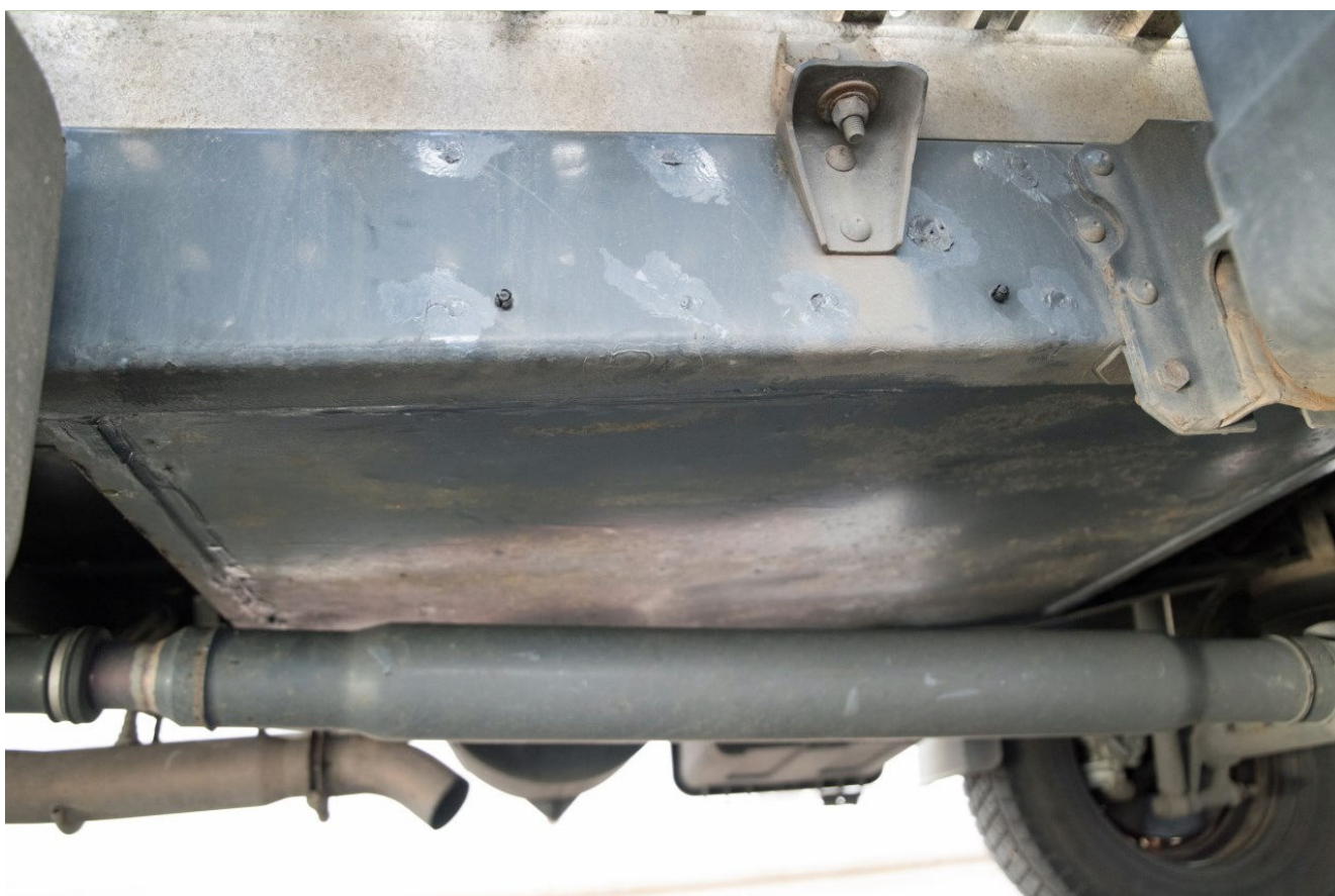
Bild 13. En konstruerad låda i underredet på motsvarande plats som den djupare delen av utrymmet (se bild 10). Avvikande färg, grova fogar och igenspackade hål visar att fordonets originalutförande har påverkats.
