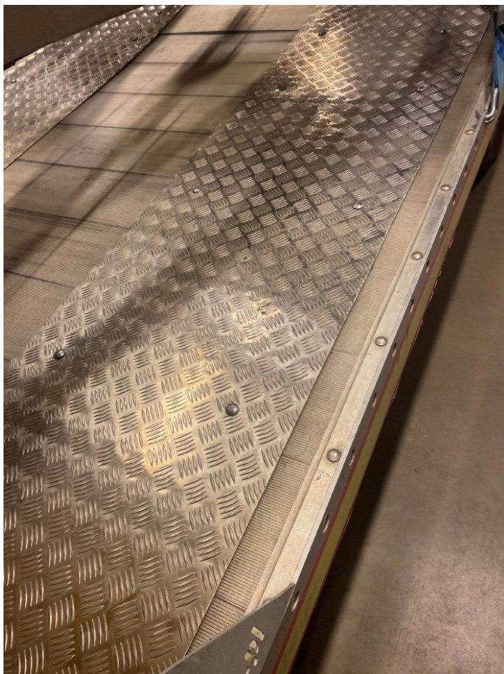
Bild 17. Golvets lösa plåtribbor har hållits på plats med hjälp av två fastskruvade tvärgående täckplåtar (bild tagen av kontrollgruppen vid beslagstillfället). För att få åtkomst till gömmans utrymme måste dessa täckplåtar skruvas loss.
