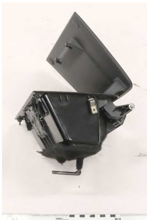
Bild 40-41. Beslag TV212-BP2023-7098-5B p.1. Instrumentpanelens toppfack, vilket måste avlägsnas för åtkomst till gömman. Dess undersida har modifierats med en hake som låser fast i låsmekanismen inne i gömman.
