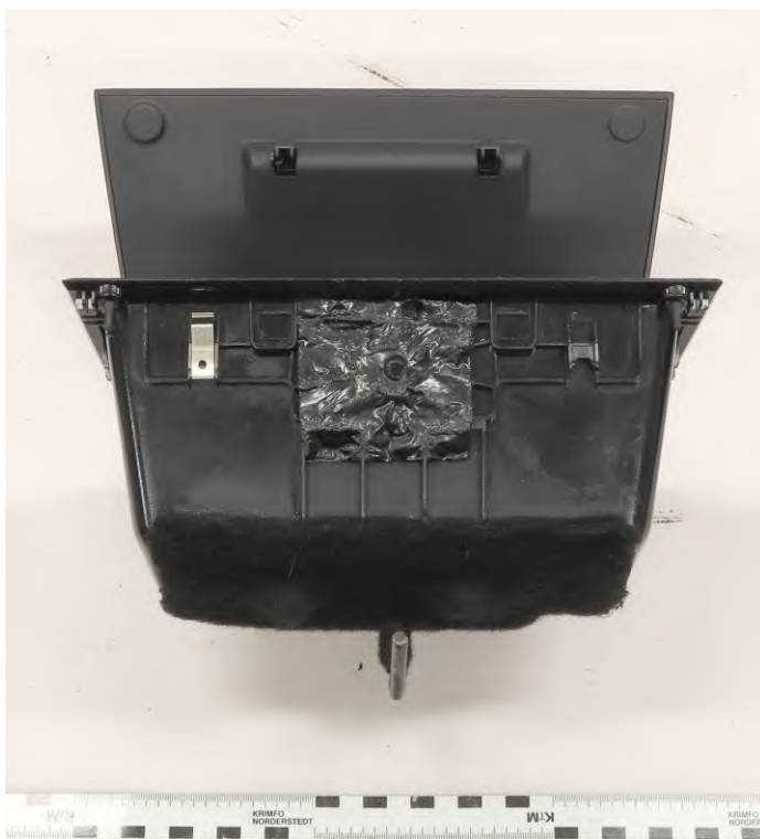
Bild 40-41. Beslag TV212-BP2023-7098-5B p.1. Instrumentpanelens toppfack, vilket måste avlägsnas för åtkomst till gömman. Dess undersida har modifierats med en hake som låser fast i låsmekanismen inne i gömman.
