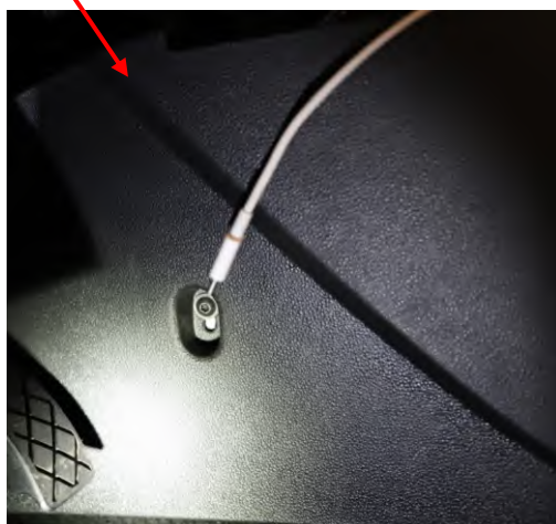
Bild 35-37. Beslag TV212-BP2023-7098-5B p.1. Gömmans låsmekanism låses genom att toppfackets hake trycks ner i låset. För att låsa upp och kunna få loss toppfacket sätts en av laddsladdarna, från 12-voltsuttaget framför växelspaken, mot en skruv i förarplatsens plastkåpa mot mittkonsolen.
