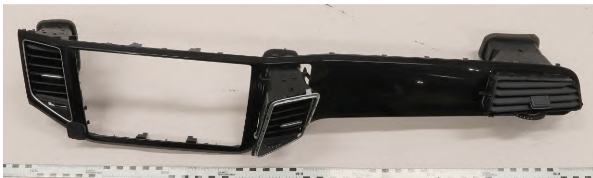
Bild 40-41. Beslag TV212-BP2023-7098-5B p.1. Instrumentpanelens toppfack, vilket måste avlägsnas för åtkomst till gömman. Dess undersida har modifierats med en hake som låser fast i låsmekanismen inne i gömman.
