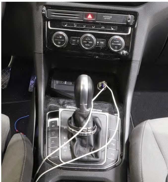
Bild 35-37. Beslag TV212-BP2023-7098-5B p.1. Gömmans låsmekanism låses genom att toppfackets hake trycks ner i låset. För att låsa upp och kunna få loss toppfacket sätts en av laddsladdarna, från 12-voltsuttaget framför växelspaken, mot en skruv i förarplatsens plastkåpa mot mittkonsolen.
