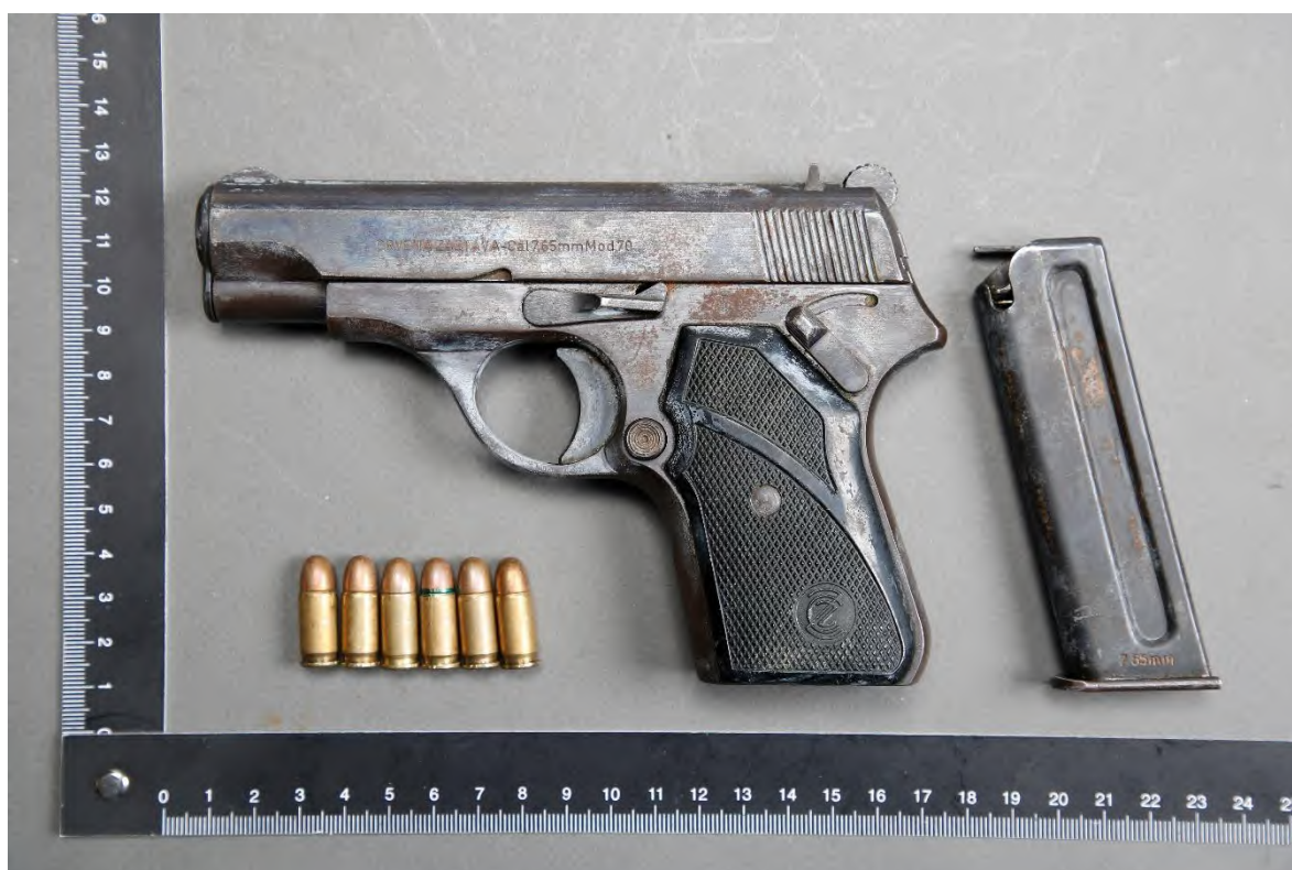
Figur 1. Studiofotografering av den undersökta pistolen med passande magasin, Tullverkets beslag TV212-BP2023-7081-52-1—2 . De sex kulpatronerna som ses på bilden ska, enligt uppgift, initialt ha suttit i magasinet. Kulpatronerna och magasinet passar till den undersökta pistolen. Det finns en mindre mängd ytrost på pistolen och magasinet men detta är inget som påverkar funktionen.
