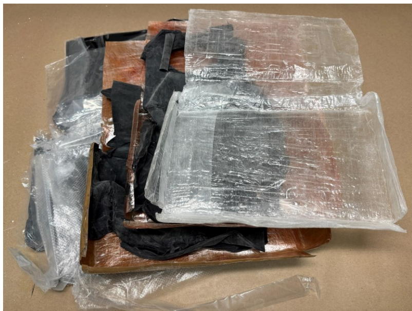
Bild 60. TV212-BP2023-7545-53 p.3 Förpackningarnas emballagelager bestod utifrån och in av svart isoleringstejp, vakuumpåse, plastfolie, vakuumpåse, transparent packtejp, brun packtejp, gummiemballage, plastfolie, gummiemballage och en vakuumförpackning.
