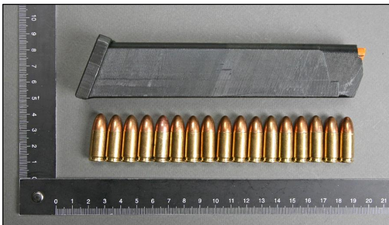
Figur 4. Del av beslag 2023-5000-BG19787-1:1, egentillverkat magasin till kulsprutepistol med patroner som satt i magasinet.
