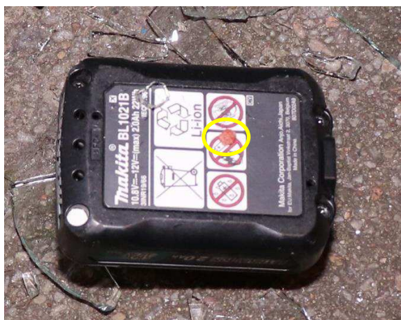
Figur 13. Detaljbild på verktygsbatteri (G002). Markering visar rosafärgad klump.
