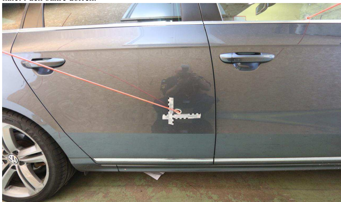
Bild 6. Markeringsstaven på högra bakdörren visar en ungefärlig skottvinkel.
