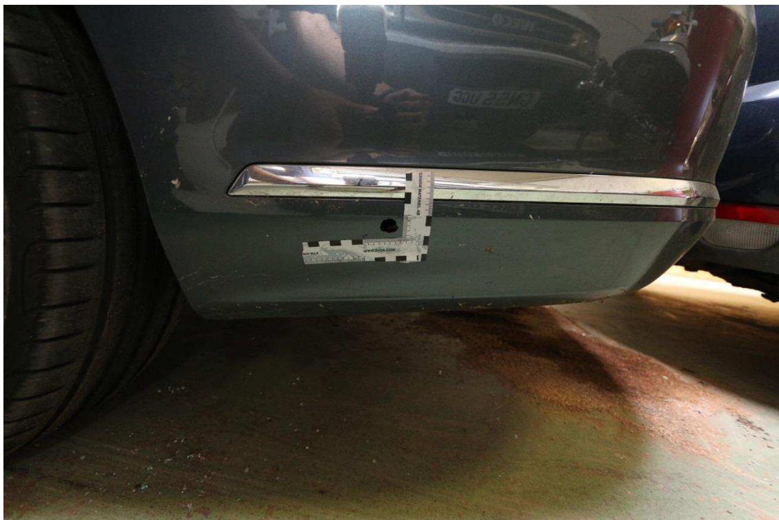
Bild 2. Markeringen visar storleken samt placeringen av det anträffade hålet.
