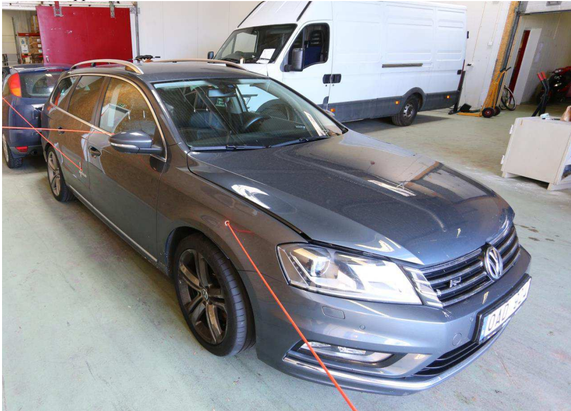
Bild 3. På bilden syns de anträffade hålen markerade med stavar som markerar riktning.
