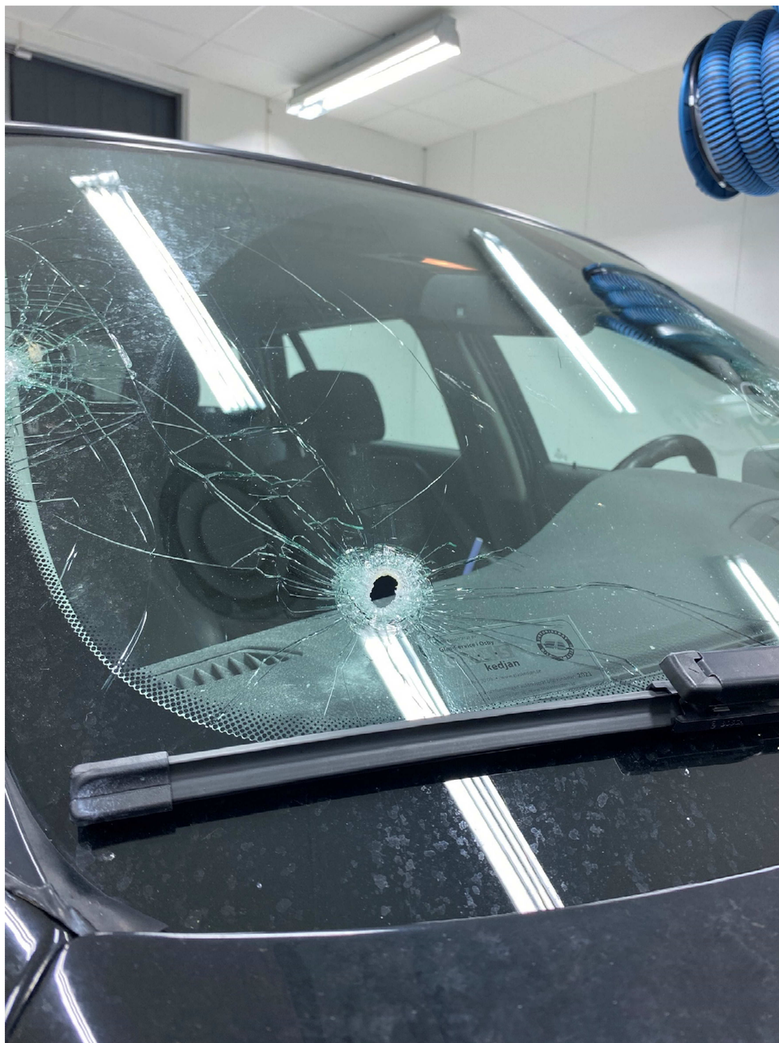
Figur 7. Exempel på genomgående hål i framrutan.
