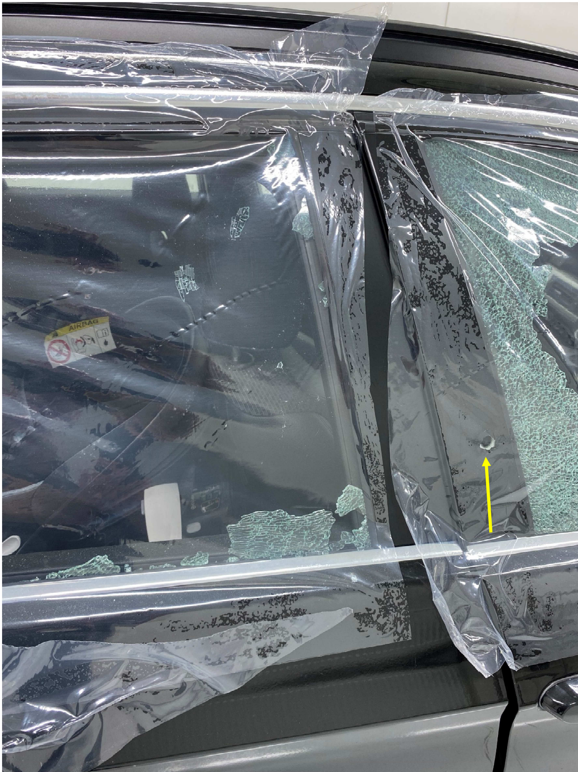
Figur 4. Visar krossade rutor på högersidan av bilen och hål i plåten i passagerardörren höger fram. I baksätet syns del av en barnstol.
