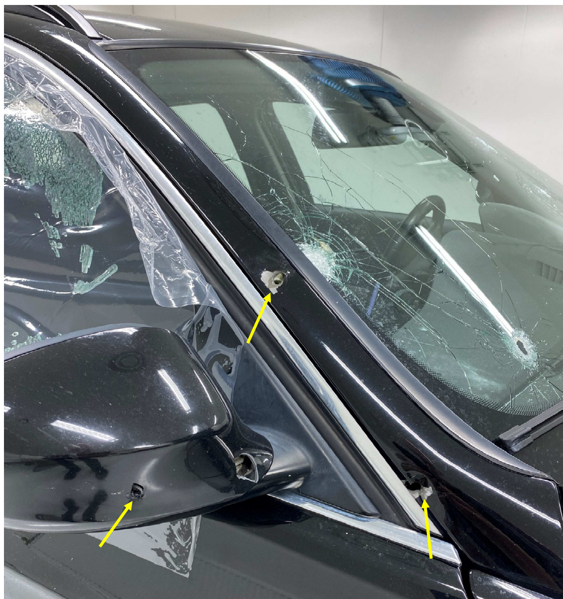
Figur 2. Exempel på skador i plåt och glas höger sida i bilens körriktning.
