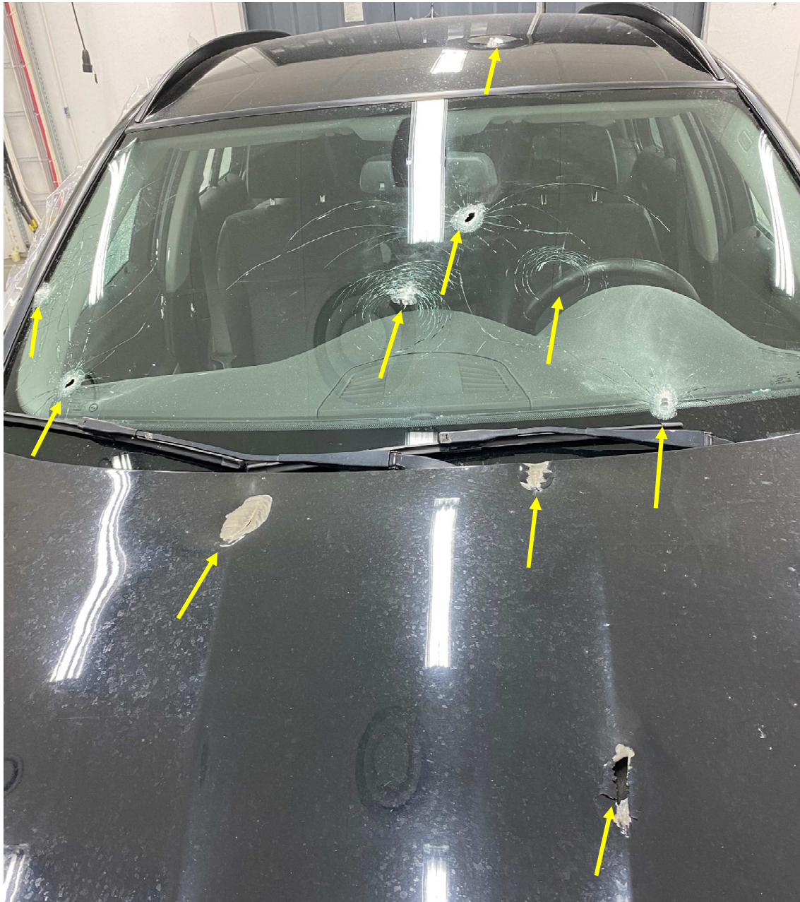
Figur 1. Visar motorhuv och framruta. Pilarna visar exempel på skador i plåt och framruta.
