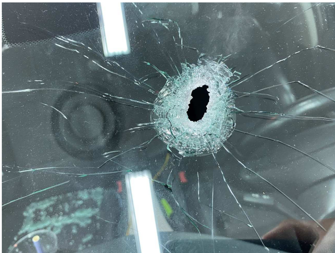
Figur 8. Exempel på ytterligare genomgående hål i framrutan.
