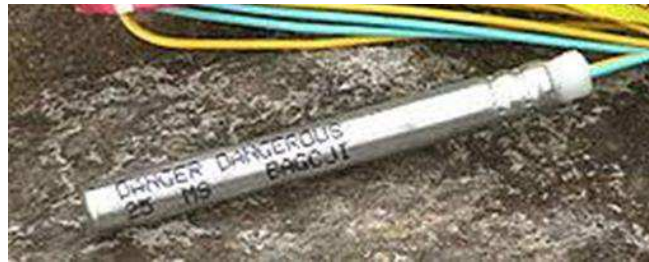
Figur 2. Foto på elsprängkapsel.
